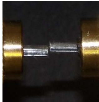
Figura 73 Desalineamiento transversal Axis Y .
