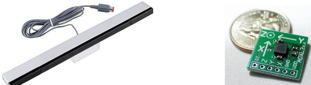
Ilustración 9. (Izquierda) Barra de sensores Leds infrarrojos de la Wii y (Derecha) acelerómetro ADX1330.
