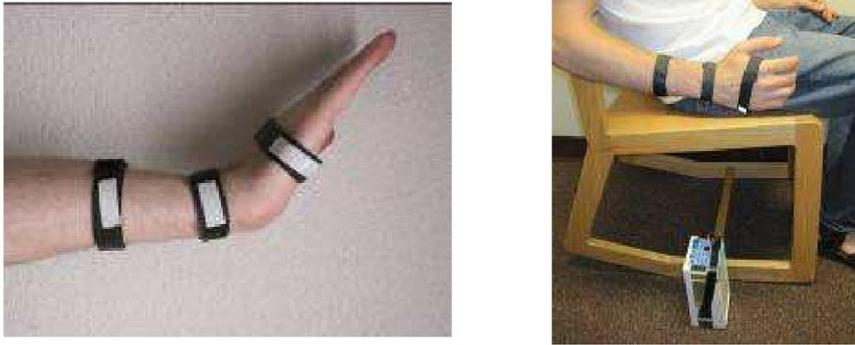
Ilustración 10. (Izquierda) Posición de las correas de velcro que sujetan los sensores infrarrojos y (Derecha) la posición del sensor infrarrojo del Wiimote® para la realización del ejercicio en una posición sentada.
