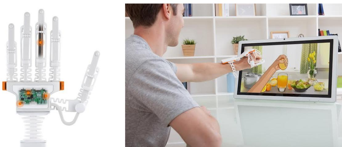
Ilustración 28. (Izquierda) Dispositivo [Smart Glove] y (Derecha) paciente usando el dispositivo en un videojuego de AVD.
