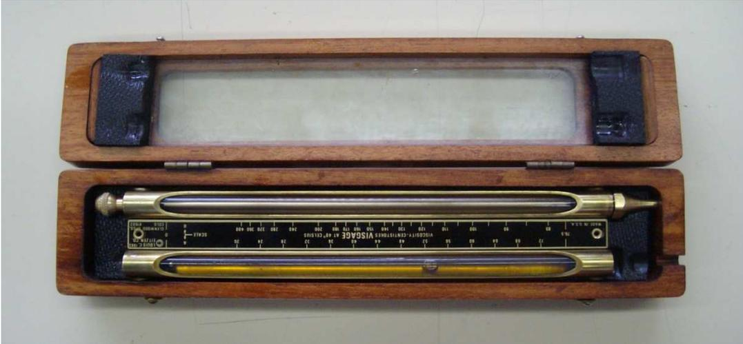
El Visgage mide la viscosidad del aceite en el lugar de la medición de una forma fácil y rápida. Puede ser utilizado para comprobar casi cualquier aceite, desde aquellos de uso ligero (20cSt) hasta los aceites pesados de engranaje (400sCt) para éste modelo de viscosímetro.
