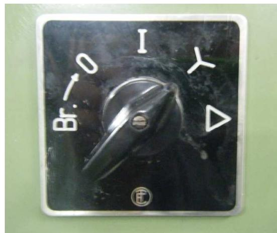
FIGURA 11 B. Conexión en **Y** (estrella)
