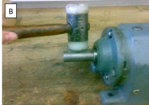
**13. COLOCAR EL MANGÓN DERECHO EN EL ACOPLAMIENTO.**
