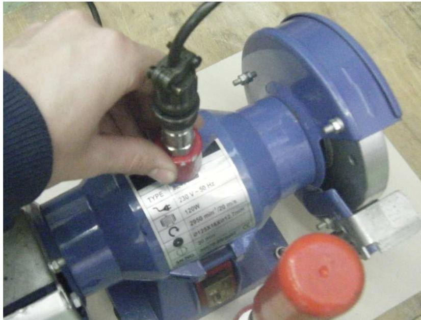
Figura 18: Sujeción del sensor piezoeléctrico en la Afiladora
