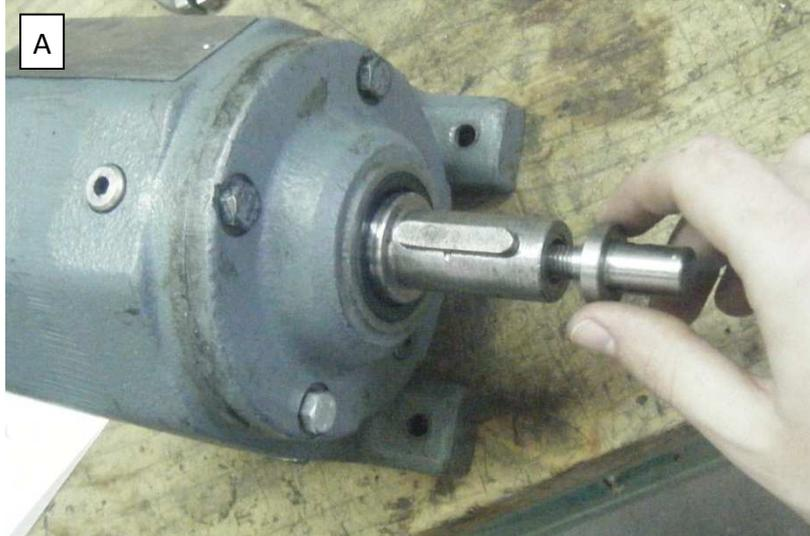
**6. EXTRAER CHAVETA DEL EJE DEL REDUCTOR.**
