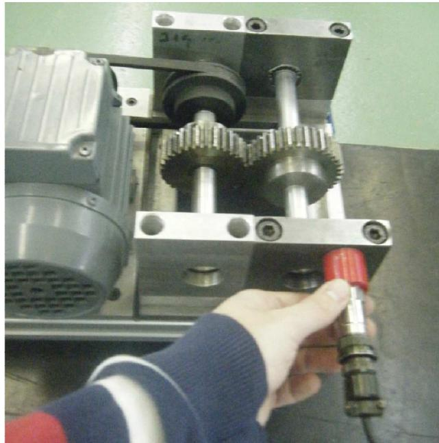
Figura 19: Sujeción del sensor piezoeléctrico en la Máquina Nueva
