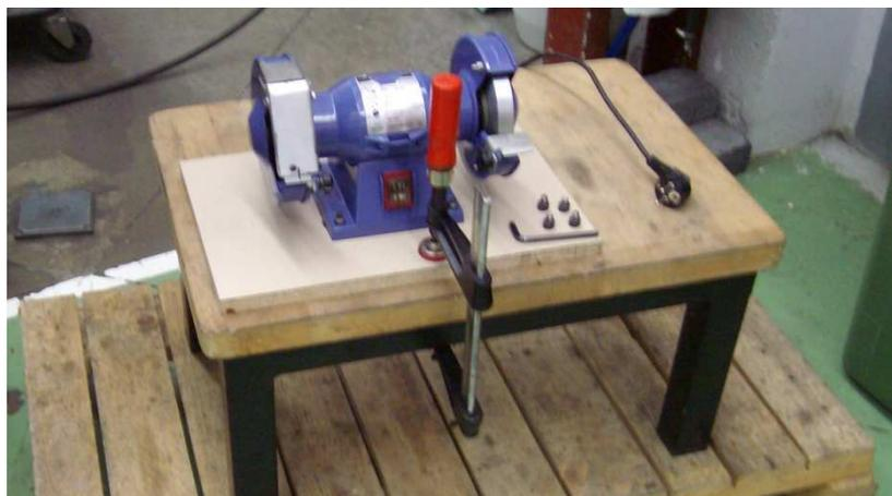
FIGURA 2: Disposición de la máquina Afiladora
