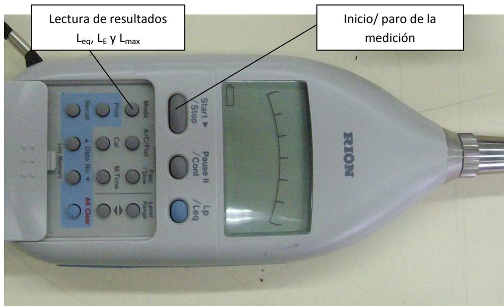
FIGURA 2: Botones importantes para realizar la medición
