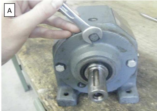
**11. COLOCAR 4 TORNILLOS DE CABEZA REDONDA DE LUBRICACIÓN**
