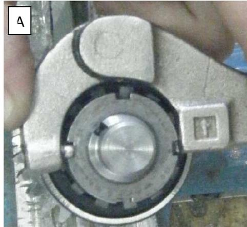
9. UNIR EL EJE AL MANGÓN DEL ACOPLAMIENTO MEDIANTE PASADOR ELÁSTICO.
