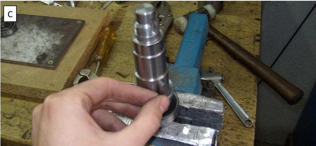
**13. CAMBIO DE DISPOSICIÓN DEL EJE SOBRE EL TORNILLO DE BANCO.**
