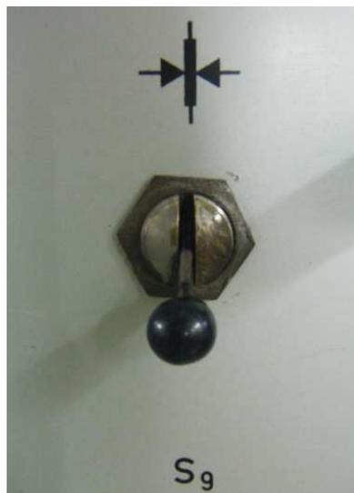
FIGURA 7A. Conmutador **S9** abierto
