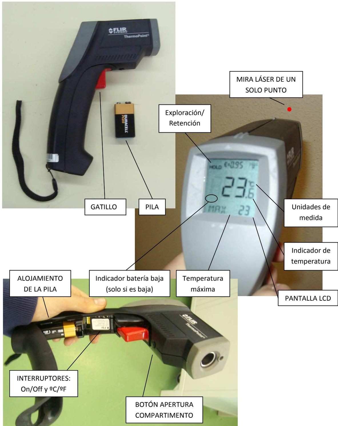
FIGURAS 1: Termómetro sin contacto FLIR TP T2 Pro
