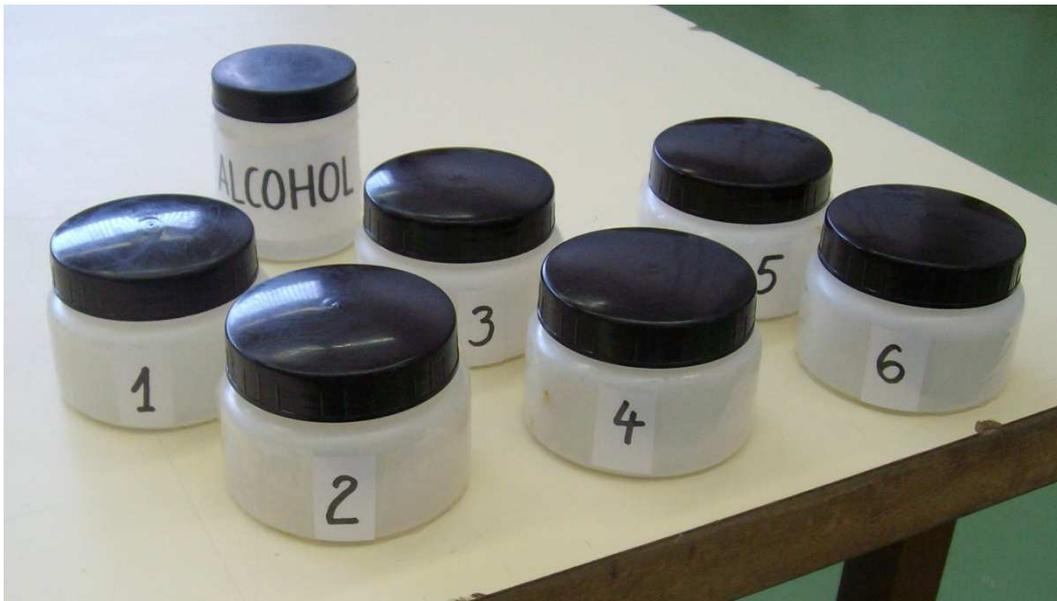
Para tener una idea de los resultados que se va a obtener, puede decirse que los seis aceites se mueven en un rango aproximado de viscosidad cinemática de entre 25 y 130 cSt cuyas medidas fueron tomadas a una temperatura ambiente (TA) de 22°C. Si la TA fuera mayor la viscosidad sería menor, y SI la TA fuera menor la viscosidad sería mayor.
