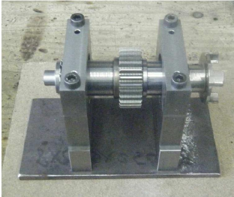
Subconjunto derecho. Se identifica como un reductor con un eje saliente hacia el centro del montaje total:
