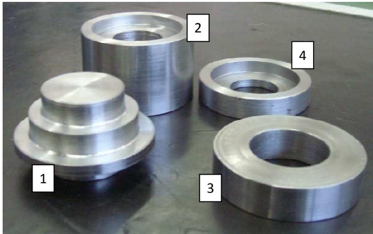
Además, durante la práctica se van a tener que colocar los ejes sobre el tornillo de banco para realizar operaciones de montaje o desmontaje. Para ello se dispone de unos soportes auxiliares de montaje que se colocan en el banco como se explica en la figura:
