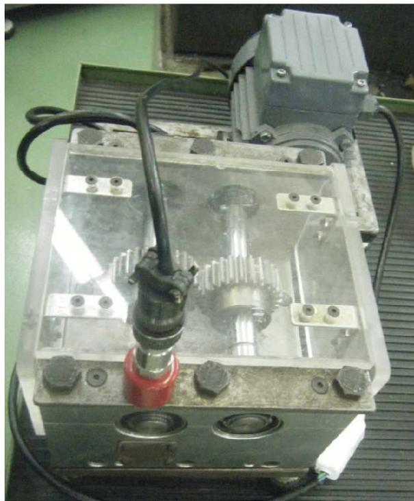
Figura 20: Sujeción del sensor piezoeléctrico en el Simulador
