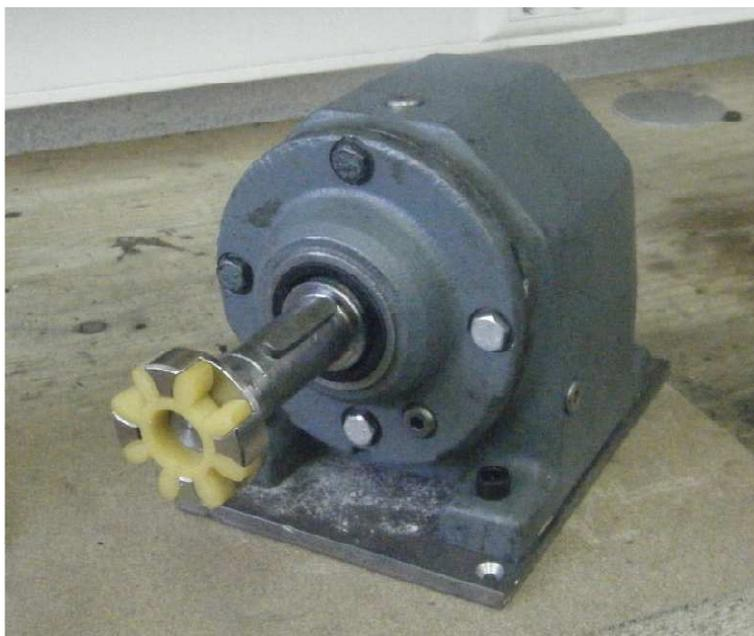
Elemento central. Se trata de un acoplamiento elástico tipo Rotex capaz de transmitir el movimiento entre las partes izquierda y derecha del conjunto, absorbiendo las desalineaciones entre ambos ejes y amortiguando las vibraciones de giro que pudieran darse:
