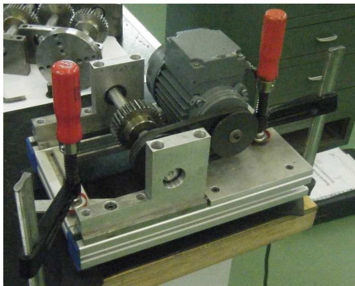
Figura 5: Anclaje de la Máquina Nueva
