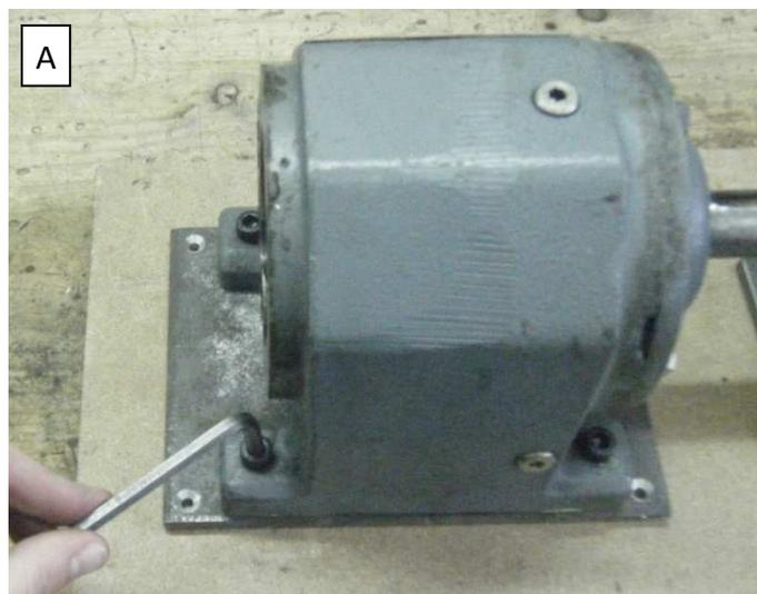
**16. FIJAR LA UNIÓN DEL EJE AUXILIAR CON EL MANGÓN DERECHO DEL ACOPLAMIENTO.**
