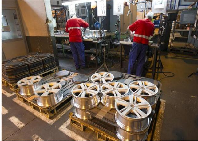
Como protecciones colectivas hay protecciones de metacrilato para evitar la proyección de virutas de aluminio. Las lijadoras usadas cuentan con el marcado CE.
