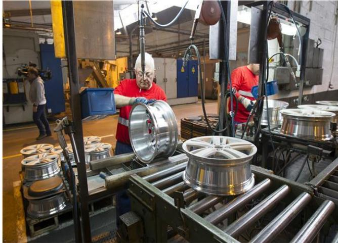
Como protecciones colectivas hay protecciones de metacrilato para evitar la proyección de virutas de aluminio. Las fresadoras usadas cuentan con el marcado CE.
