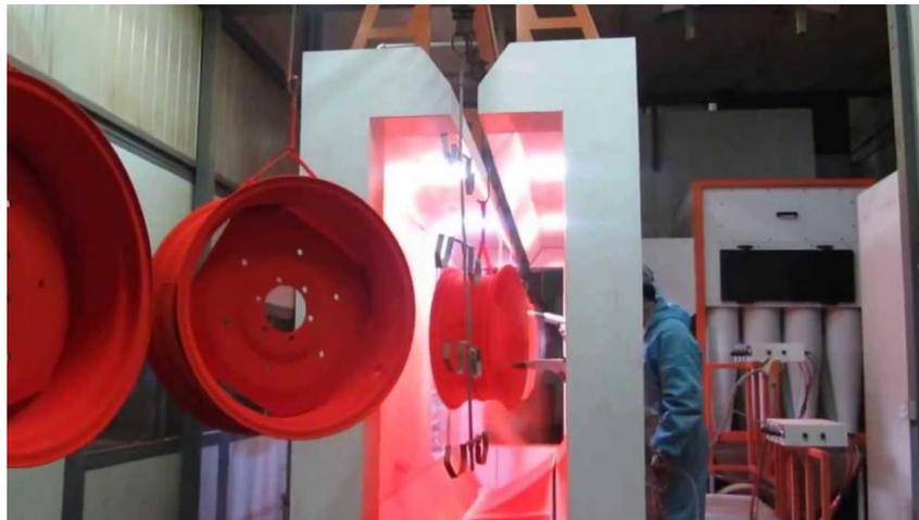
Como protecciones colectivas hay protecciones de cabinas para evitar la proyección de pintura al exterior o de gases tóxicos. Las pistolas usadas cuentan con el marcado CE.
