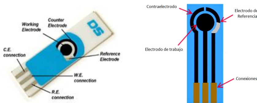
Figura 2. (a) Electrodo serigrafiado DS550 (b) Desglose interno del electrodo serigrafiado.
