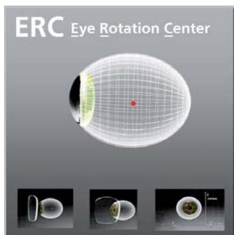
Ilustración 6: Eyecode: mide la distancia al centro de rotación del ojo significa que las lentes se pueden personalizar con más precisión. Este punto es una referencia óptica.
