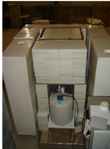
Figura 1: Dispositivo experimental: blindaje a medio construir (izquierda) y blindaje completo (derecha). El detector de Germanio se encuentra en el centro del blindaje de plomo.
