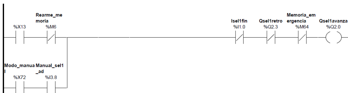
Figura 4.15. Programación de una salida en el POST.
