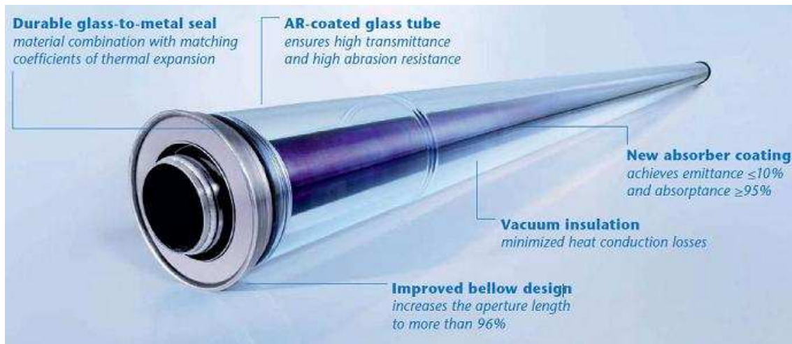
Figura 13: Diseño del tubo Schott PRT 70
