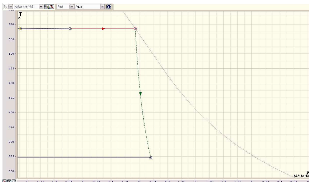
Figura 52: Proceso adiabático irreversible que tiene lugar en las turbinas
