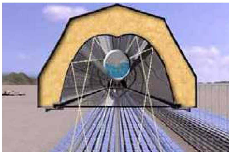
Figura 29: Esquema simplificado del reflector secundario en la planta PE1
