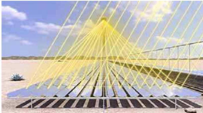
Figura 25: Esquema simplificado de la trayectoria de los rayos solares
