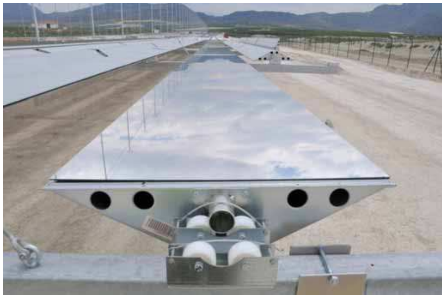
Figura 26: Reflector primario de la planta PE1
