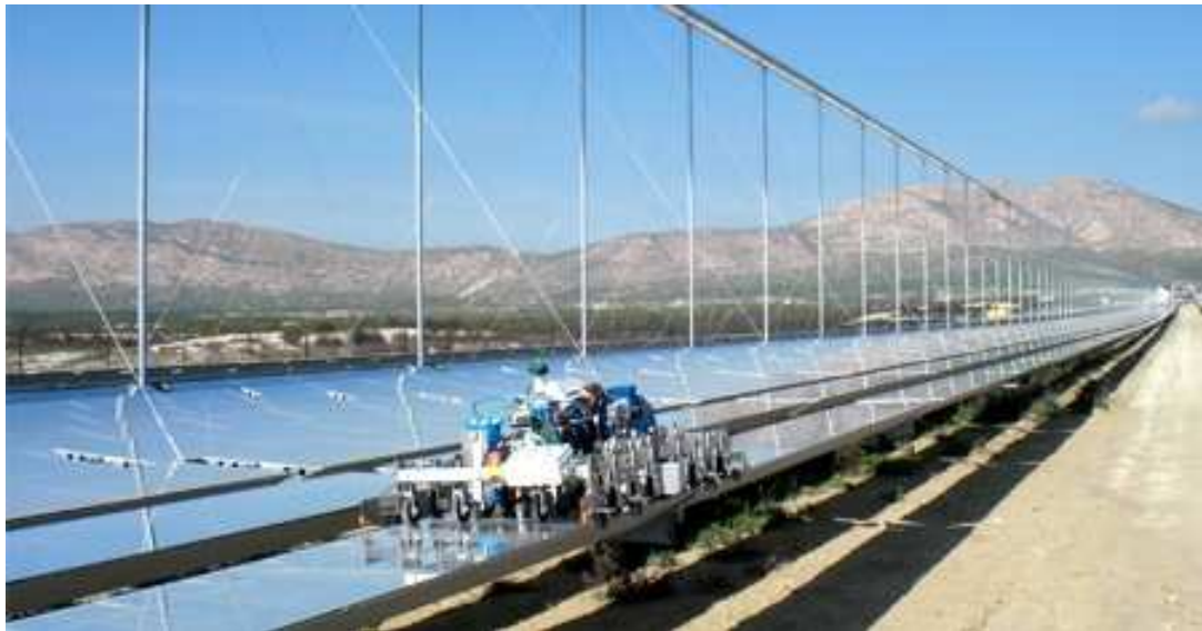
Figura 38: Limpieza automatizada de los espejos en la PE1
