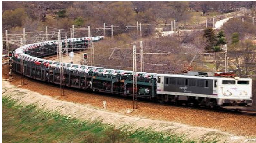
Figura 16. Locomotora 269 de RENFE Mercancías arrastrando una composición de vagones porta-coches.
