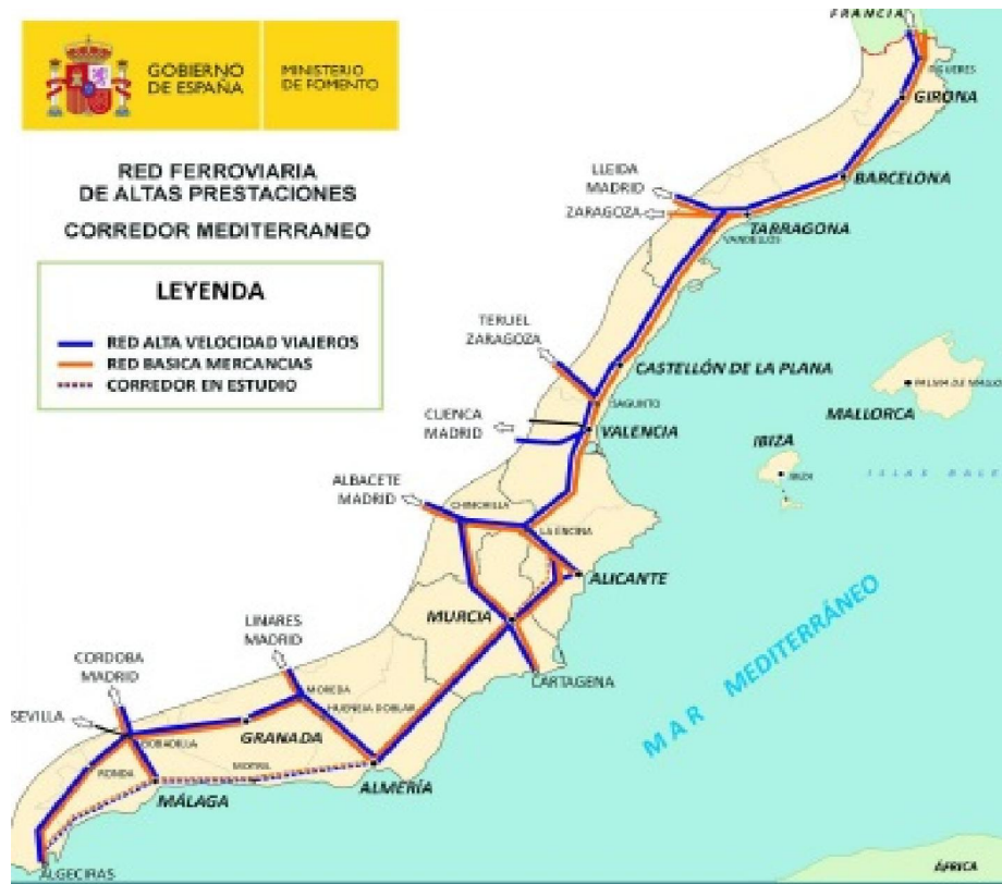
Figura 7. Imagen final de la Infraestructura Ferroviaria del Corredor Mediterráneo, conectando con todos los puertos e instalaciones logísticas, permitiendo los pasos de trenes de hasta 750 m de longitud e independizando los tráficos de mercancías con los de viajeros.
