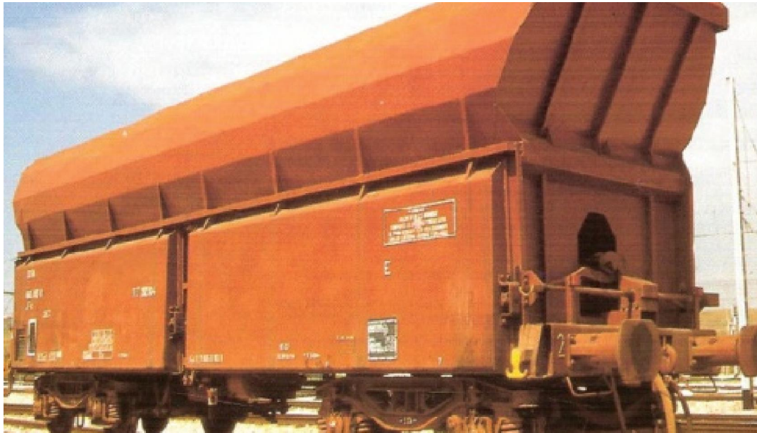
Figura 3. Vagón Tolva abierta para el transporte de productos diversos. Tipo TT6.
