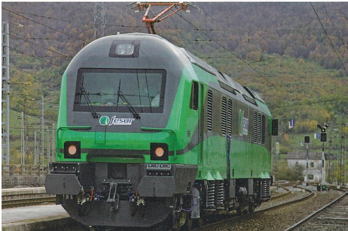
Figura 8. Locomotora Bitrac 3600, serie 601 encargada por la empresa Fesur (Ferrocarriles del Suroeste).
