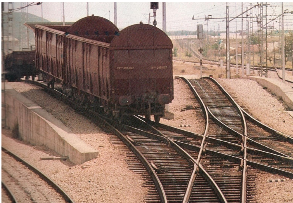
Figura 8. Un vagón con techo abierto es lanzado por el lomo de asno y dirigido por la vía para su posterior clasificación.
