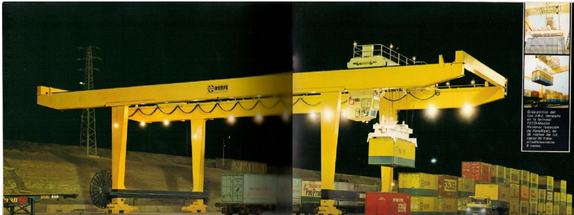
Figura 18. Grúa-pórtico del tipo 2.6.2, instalada en la terminal TECO-Madrid Nacional ( estación de Abroñigal).
