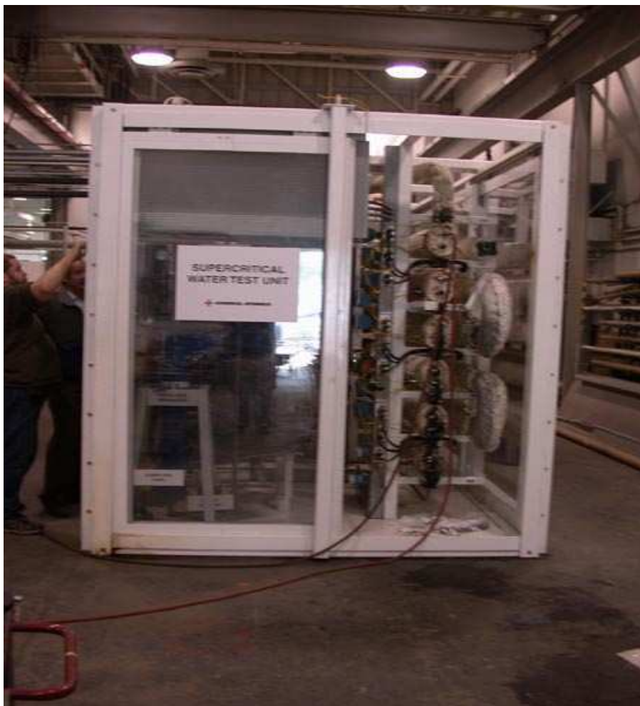
Figura 6.6. Planta piloto de agua supercrítica de gasificación integrado por Georgia, para demostrar la conversión de residuos orgánicos en diversas formas de combustible de gas de síntesis.
