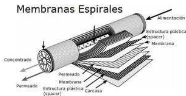
Figura 2.3. Membrana enrollada en espiral.
