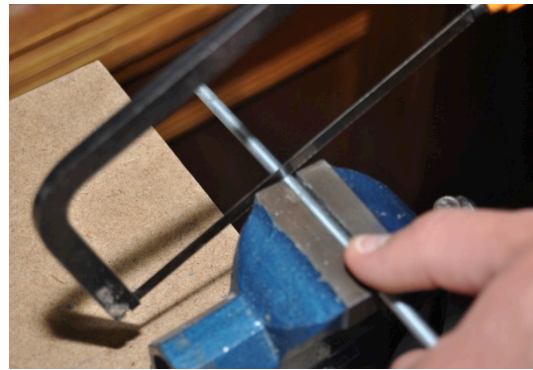
Imagen 4.24 Taladrado de los agujeros para alojar los ejes (izquierda) y corte de los ejes de varilla roscada (derecha).
