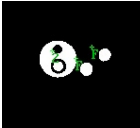
Imagen 4.8 Imagen procesada de Reactivision, en la cual se observa que la detección es correcta, ya que se le ha asignado al fiducial su número de identificación (2) y se han detectado los dos tokens (F).
