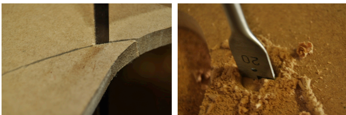
Imagen 4.43 Proceso de fabricación con DM. Corte con una sierra de calar (izquierda) y taladrado (derecha).
