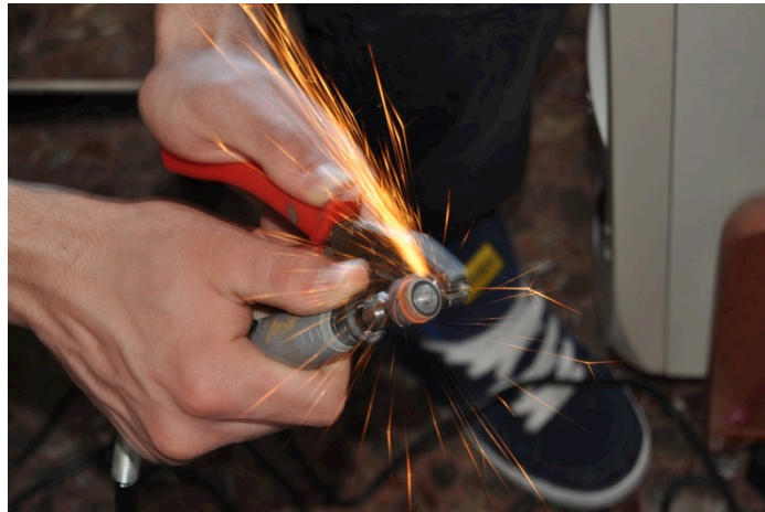
Imagen 4.112 Adaptación de las piezas metálicas de la grapadora.
