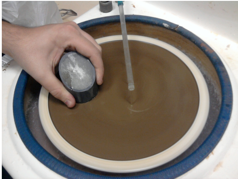
Imagen 4.67 Pulido de las superficies de fibra óptica.
