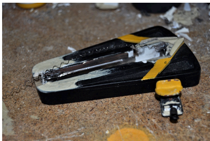
Imagen 4.113 Muelle dado de sí y ranura en la parte posterior para poder sacar el disparador.
