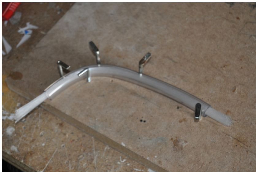
Imagen 4.56 Fibra óptica introducida en un tubo de silicona flexible, forzando la forma que se desea que permanezca tras el secado de la resina epoxy.
