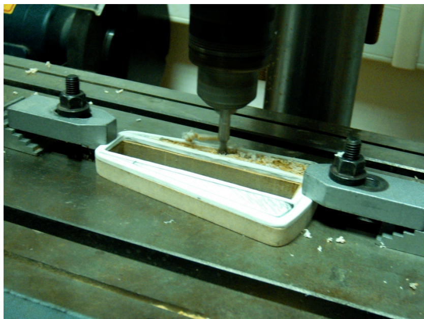
Imagen 4.111 Mecanizado mediante fresadora del tirachinas.
