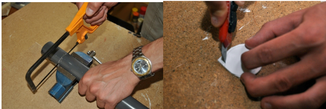
Imagen 4.101 Cortado de tubo de PVC y tapas para el agitador.
