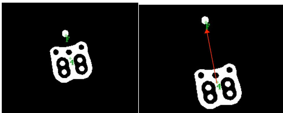
Imagen 4.117 Imagen procesada del fiducial del tirachinas con muelle en reposo (izquierda) y estirado (derecha) con el vector que forman.
