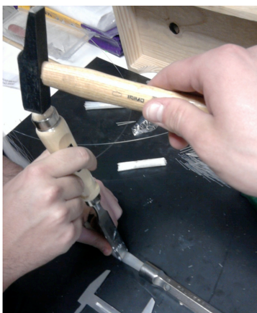
Imagen 4.64 Proceso seguido para cortar la fibra óptica.
