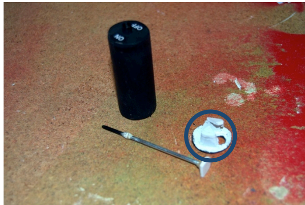
Imagen 4.99 Mecanismo interno y pestañas de interruptor sin ensamblar.
