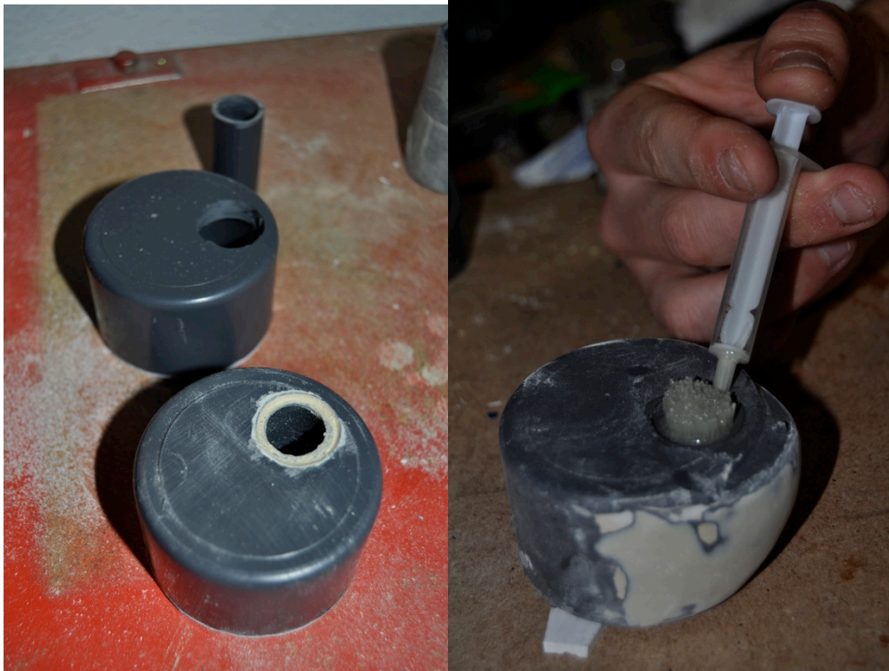
Imagen 4.78 Orificios y tubo donde se introduce la fibra óptica (izquierda) e inyección de resina epoxy (derecha).
