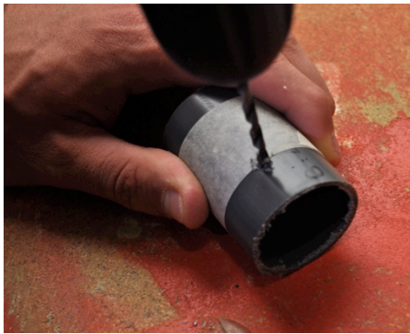
Imagen 4.24 Taladrado de los agujeros para alojar los ejes (izquierda) y corte de los ejes de varilla roscada (derecha).
