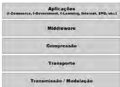
Figura 1. Arquitectura en capas del sistema de la televisión digital
