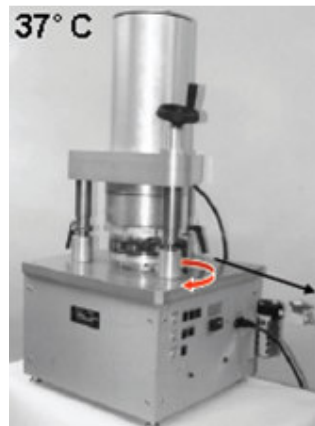
Ilustración 13 A- Pin-On-Plate desgaste carga 80N
