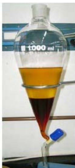
Figura 5: Fotografía de las dos fases: biodiésel y glicerina.
