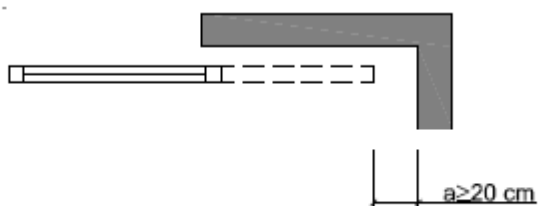
Figura 2.1 Holgura para evitar atrapamientos
