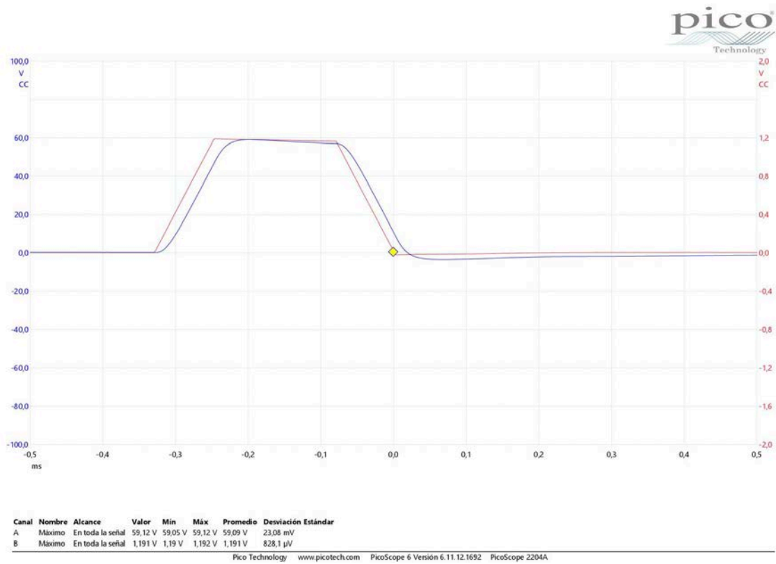
Figura 15 – Pulso rectangular con un voltaje de entrada 1191mV (en rojo) y voltaje en la carga de 1k \Omega (azul).
