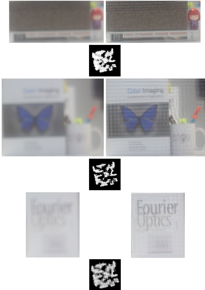
Figura D.4: Resultados de la apertura óptima para \sigma = 0.0005 . Se muestran, de arriba a abajo, resultados para tres profundidades de desenfoco distintas (40, 60 y 90 centímetros respectivamente). Para cada profundidad, izquierda: imagen capturada con blur por desenfoco, derecha: imagen obtenida tras recuperar la información perdida en la captura, abajo: PSF de la apertura utilizada.
