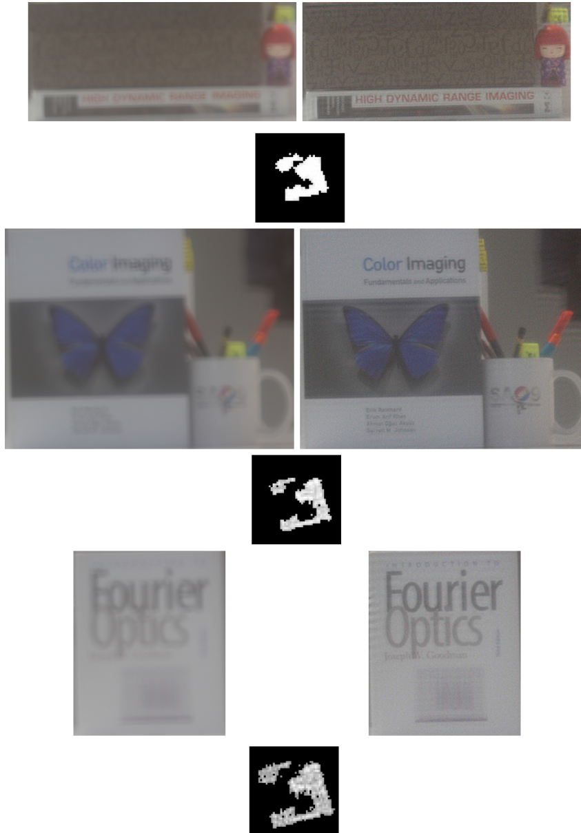
Figura D.6: Resultados de la apertura óptima para \sigma = 0.005 y tamaño 7 \times 7 . Se muestran, de arriba a abajo, resultados para tres profundidades de desenfoco distintas (40, 60 y 90 centímetros respectivamente). Para cada profundidad, izquierda: imagen capturada con blur por desenfoco, derecha: imagen obtenida tras recuperar la información perdida en la captura, abajo: PSF de la apertura utilizada.
