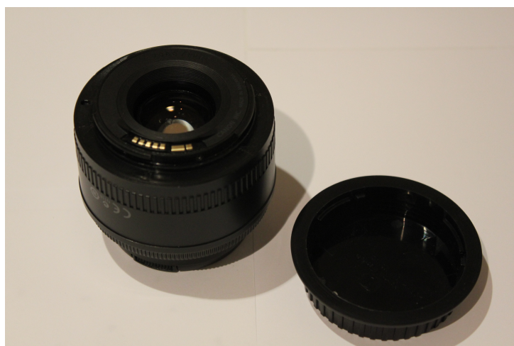
Figura B.2: Paso 01: voltear el objetivo y extraer la tapa posterior del mismo. La tapa se extrae cuando se coloca el objetivo en la cámara fotográfica.
