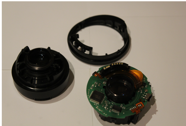
Figura B.6: Paso 05: una vez se tiene abierto el objetivo se separa el sistema de lentes del aro de enfoque (pieza circular que permite enfocar la escena en modo de enfoque manual).
