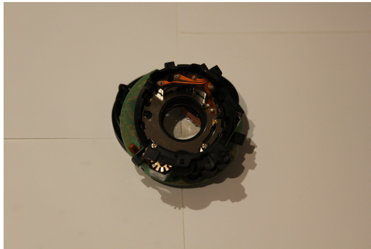
Figura B.7: Paso 06: sistema de lentes, en cuyo interior se aloja el diafragma del objetivo.
