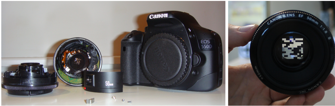
Figura 6.2: Izquierda: equipo utilizado para los experimentos reales . Derecha: apertura codificada insertada en el objetivo .
