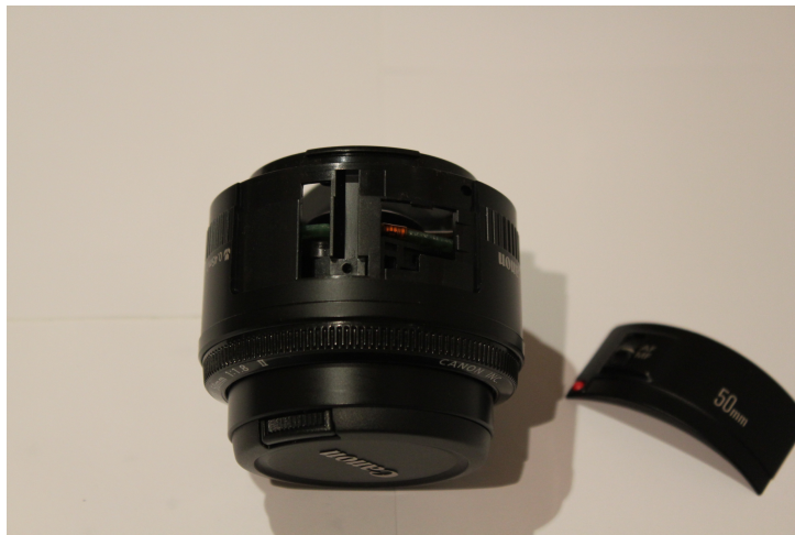
Figura B.4: Paso 03: extracción de la tapa que permite cambiar el modo de enfoque del objetivo entre modo manual y modo automático. Esto permitirá extraer la carcasa exterior del objetivo.
