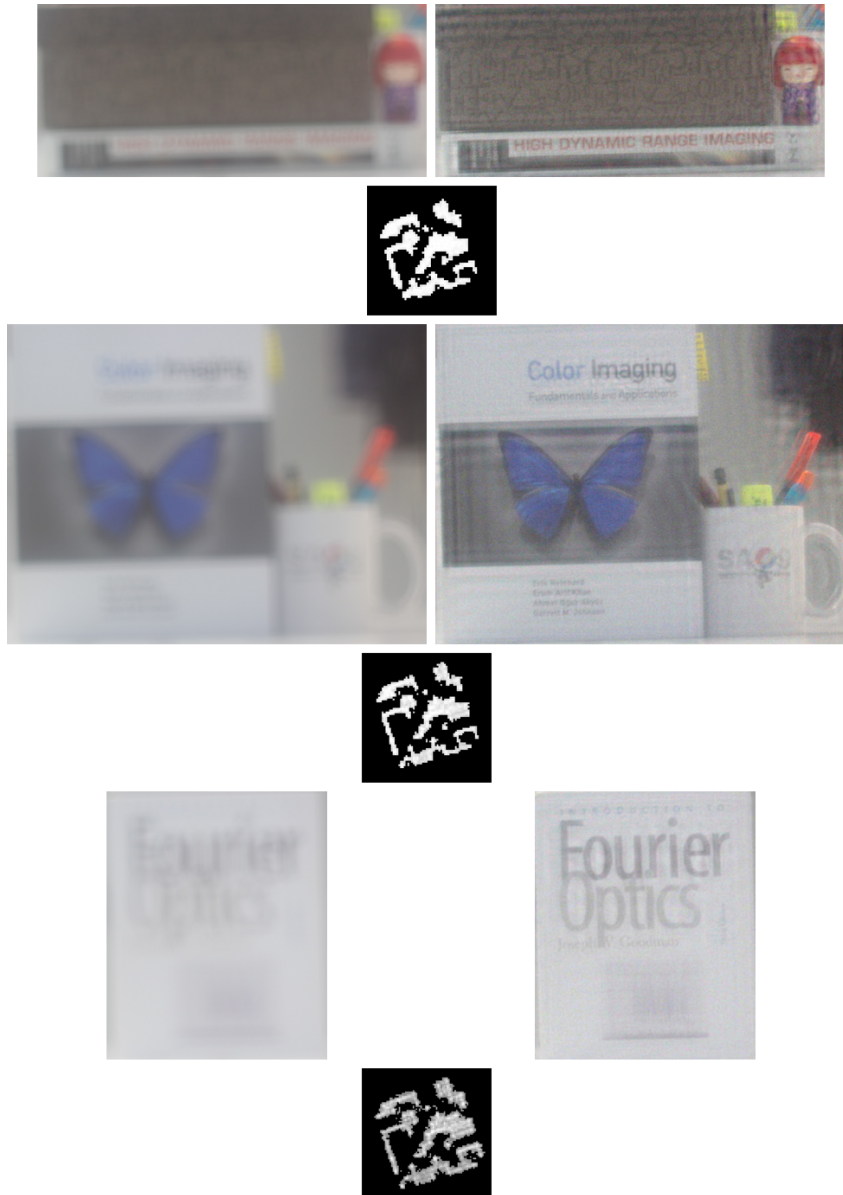
Figura D.2: Resultados de la apertura óptima para \sigma = 0.001 . Se muestran, de arriba a abajo, resultados para tres profundidades de desenfoco distintas (40, 60 y 90 centímetros respectivamente). Para cada profundidad, izquierda: imagen capturada con blur por desenfoco, derecha: imagen obtenida tras recuperar la información perdida en la captura, abajo: PSF de la apertura utilizada.
