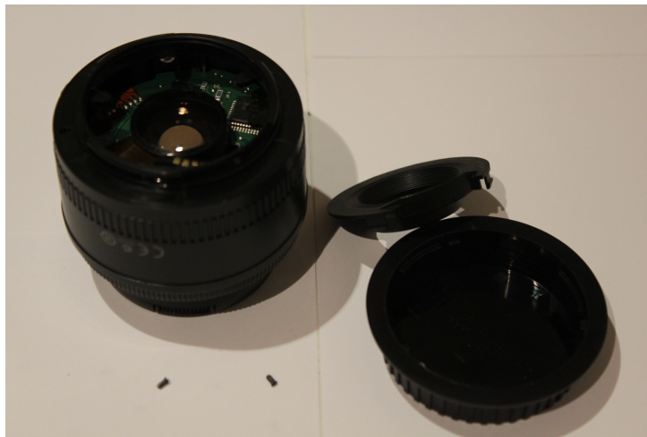
Figura B.3: Paso 02: extracción de dos micro-tornillos para, a posteriori, extraer una tapa interior (dejando visible la microelectrónica del objetivo).
