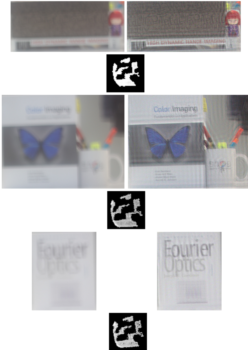
Figura D.5: Resultados de la apertura óptima para \sigma = 0.005 . Se muestran, de arriba a abajo, resultados para tres profundidades de desenfoco distintas (40, 60 y 90 centímetros respectivamente). Para cada profundidad, izquierda: imagen capturada con blur por desenfoco, derecha: imagen obtenida tras recuperar la información perdida en la captura, abajo: PSF de la apertura utilizada.
