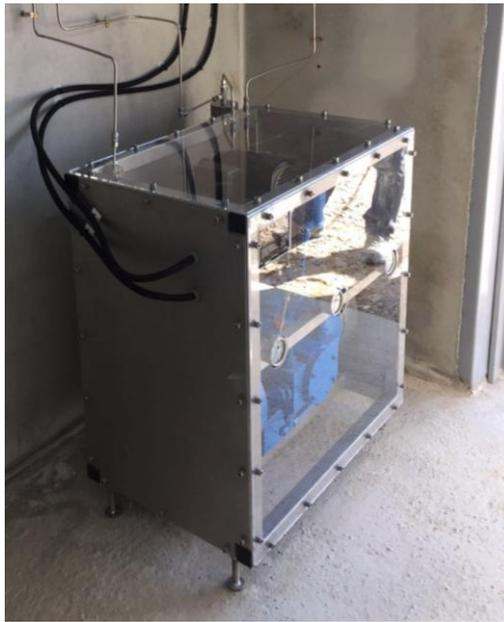
*Figura 3.19: Compresor de hidrógeno.*
