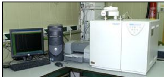
Figura AI - 3.- Analizador Carlo Erba 1108 y analizador Termo Flash 1112 para la determinación de C, H, N y S.
