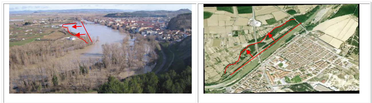
Figura 46.- Ejemplo de recuperación de la funcionalidad de la llanura de inundación mediante el retranqueo de mota (Caparroso, Navarra). Fotos: Elena Díaz (en Ollero, 2015).
