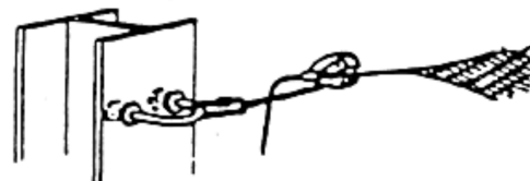
Desplazamiento de la red sobre cables portadores
