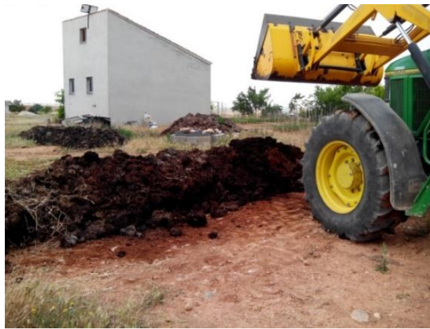
Figura 13. Volteo de cordones con un tractor John Deere 7600.
