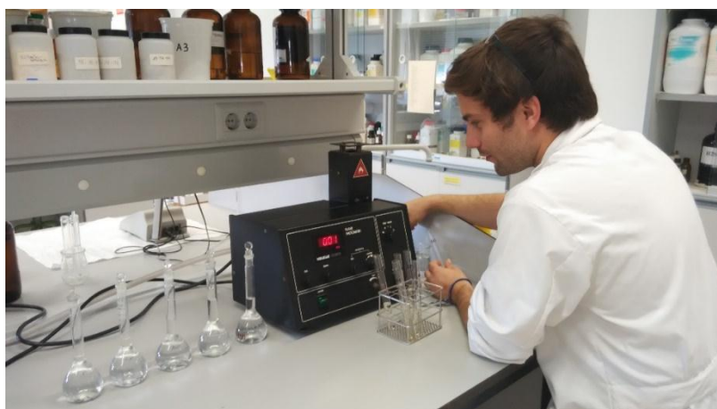
Figura 18. Determinación analítica del potasio soluble
