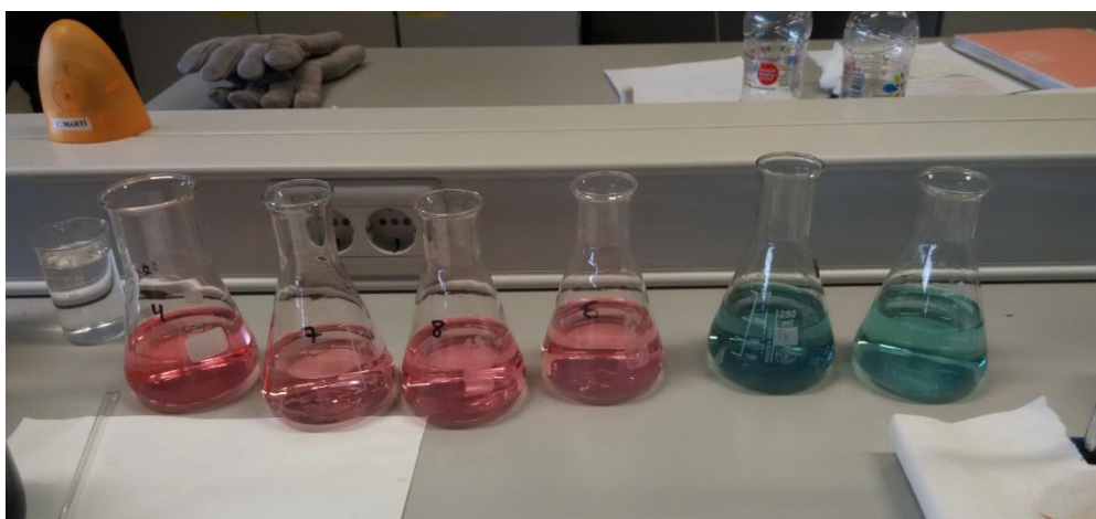
Figura 17. Determinación del nitrógeno kjeldahl total
