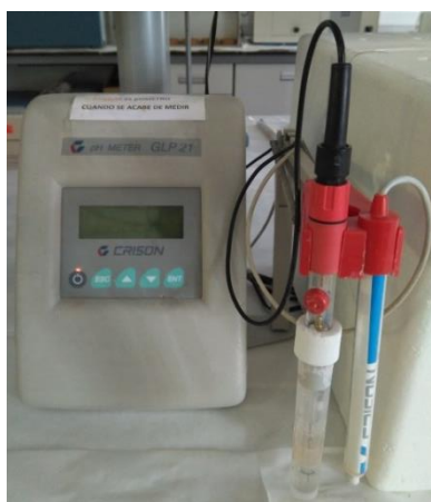
Figura 42. pH metro CRISON GLP 21. Fuente: elaboración propia.
