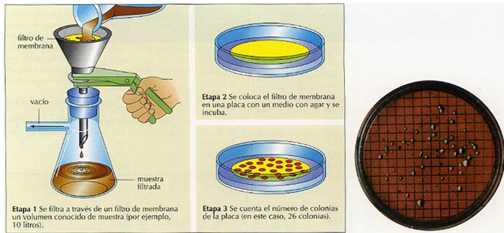
FIGURA 31. FILTRACION EN MEMBRANA. FUENTE: (RODRIGUEZ CHUECA, 2013)
