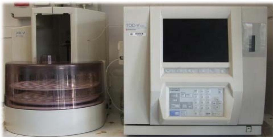
FIGURA A.3. ANALIZADOR DE CARBONO ORGÁNICO TOTAL SHIMADZU, MODELO TOC-VCSH. FUENTE: ELABORACIÓN PROPIA
