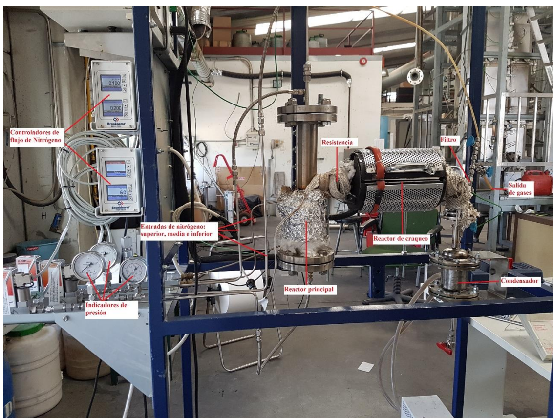
Imagen 8: Partes del reactor de pirólisis (imagen frontal).
