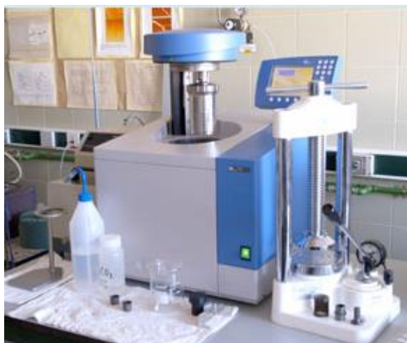
Imagen 12: Calorímetro isoperibólico IKA C-2000. Fuente: Nicolás C., 2016.
