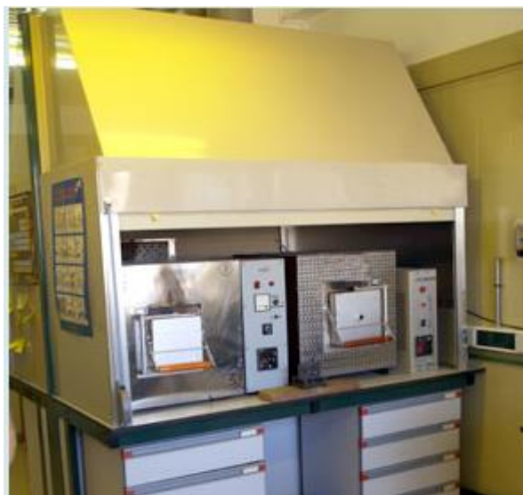
Imagen 11: Muflas de alta temperatura para realizar el análisis inmediato. Fuente: Nicolás C., 2016.
