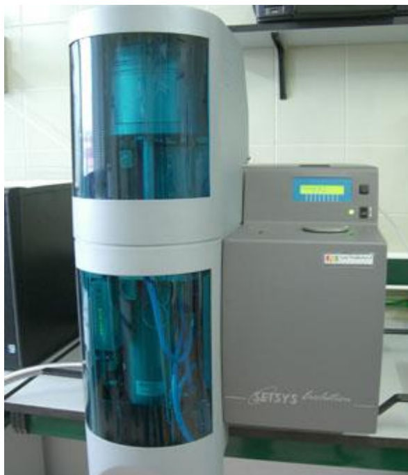
Imagen 13: Termobalanza SETARAM SetsysEvolution. Fuente: Nicolás C., 2016.
