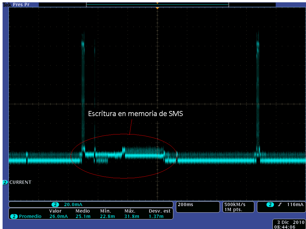
Fig. 12. Corriente consumida durante la escritura de un SMS en memoria.
