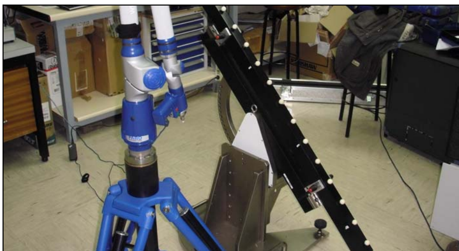
Fig. A4.13. Disposición ortogonal 2. Prueba de error indicación del tamaño de la medición. Volúmenes parciales.
