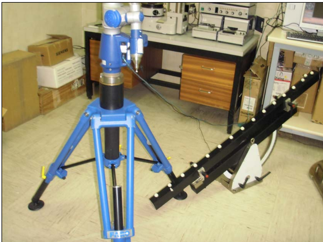
Fig. A3.29. Soporte en posición 0, distancia 'cerca', inclinación 45°, orientación radial.
