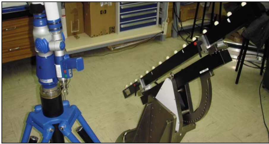
Fig. A4.12. Disposición ortogonal 1. Prueba de error indicación del tamaño de la medición. Volúmenes parciales.
