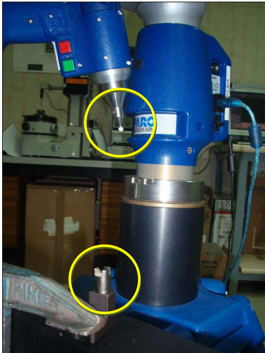
Fig. A2.1. Accesorios utilizados para la calibración del brazo.
