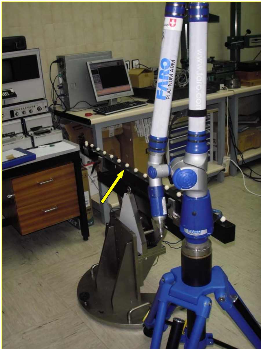
Fig. A3.1. Prueba de diámetro efectivo. Palpado de la esfera n°7.
