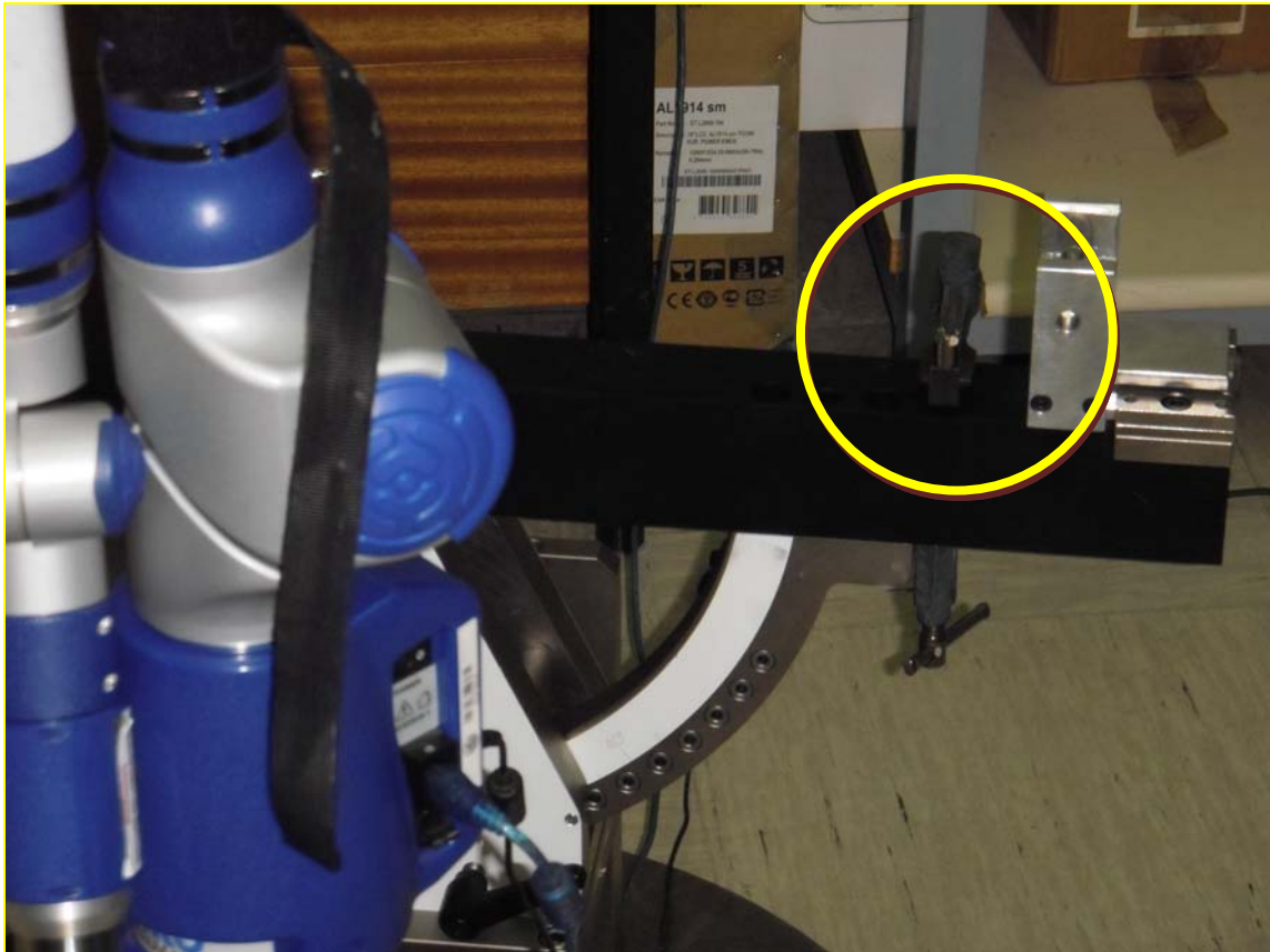
Fig. A3.10. Prueba de articulación de punto sencillo. Asiento cinemático montado sobre soporte KOBA.
