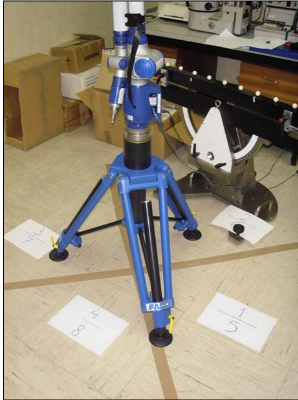
Fig. A3.26. Soporte en posición 1, distancia 'cerca', inclinación horizontal, orientación tangencial.
