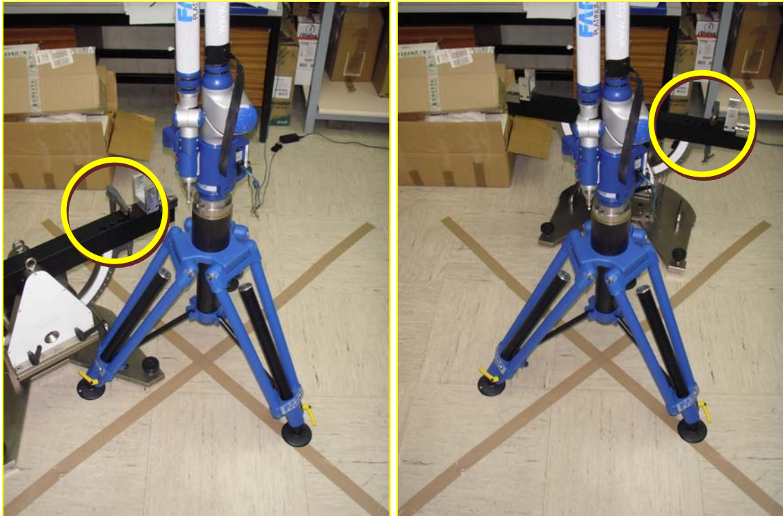
Fig. A3.11. Prueba de articulación de punto sencillo. Posiciones 0-20% (220mm) y 20-80% (700mm).
