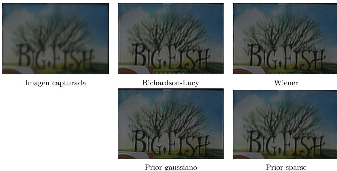
Figura 3.12: Comparación de distintos algoritmos de deconvolución para un objeto situado a 85 cm del plano focal y capturado con la apertura codificada. (Captura 2, valor de apertura f\ 3.5 , d=1.40m ).
