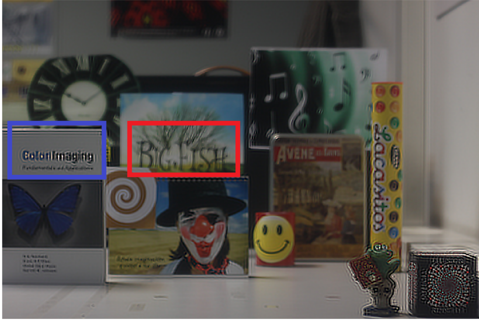
Figura 3.15: Aparición de artefactos en la deconvolución al usar un kernel de tamaño menor (caso de la zona señalada en rojo) o mayor (caso de la zona señalada en azul) del adecuado. La imagen está deconvolucionada con la PSF correspondiente a la profundidad del payaso (45cm), se puede apreciar el ringing introducido para el resto de objetos cuya profundidad es distinta y por lo tanto sus PSFs serán mayores o menores según corresponda.
