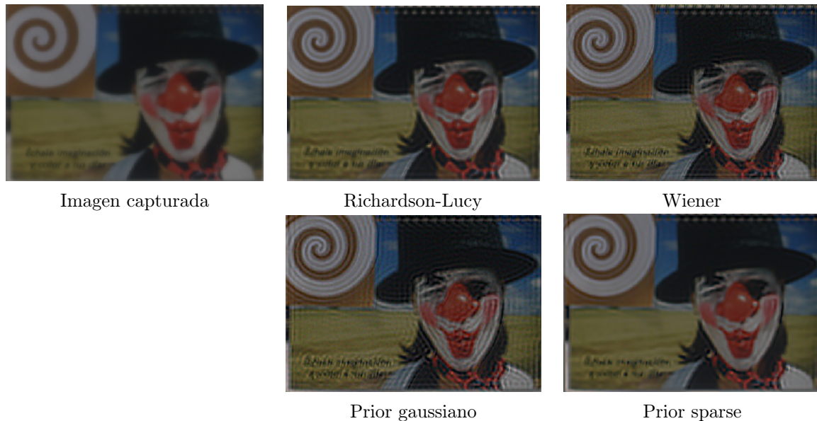
Figura 3.11: Comparación de distintos algoritmos de deconvolución de un objeto situado a 45 cm del plano focal y capturado con la apertura codificada. (Captura 1, valor de apertura f\ 2.8 , d=1.40m ).
