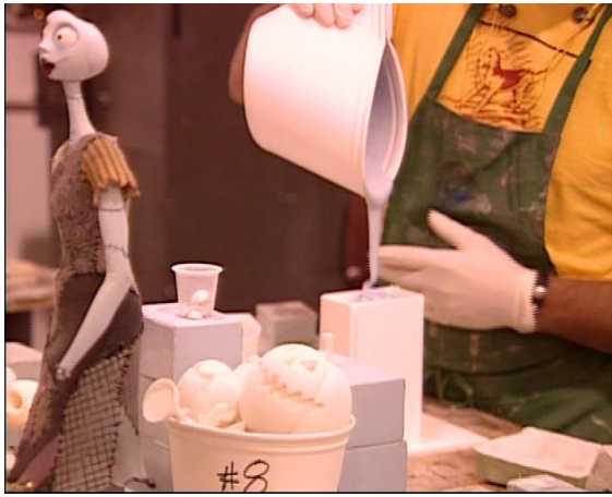
Fig. 21. Introducción del látex en el molde
