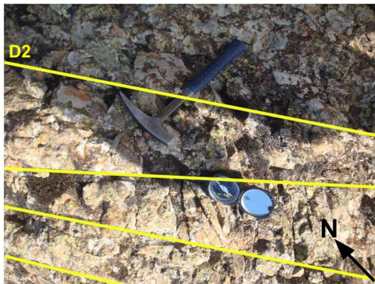
Figura 15. Esquema de la familia del diaclasado principal de las andesitas en la Estación 2.
