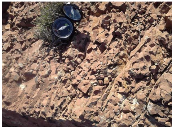
Figura 13. Orientación de la familia del diaclasado principal del encajante pérmico en la Estación 1.
