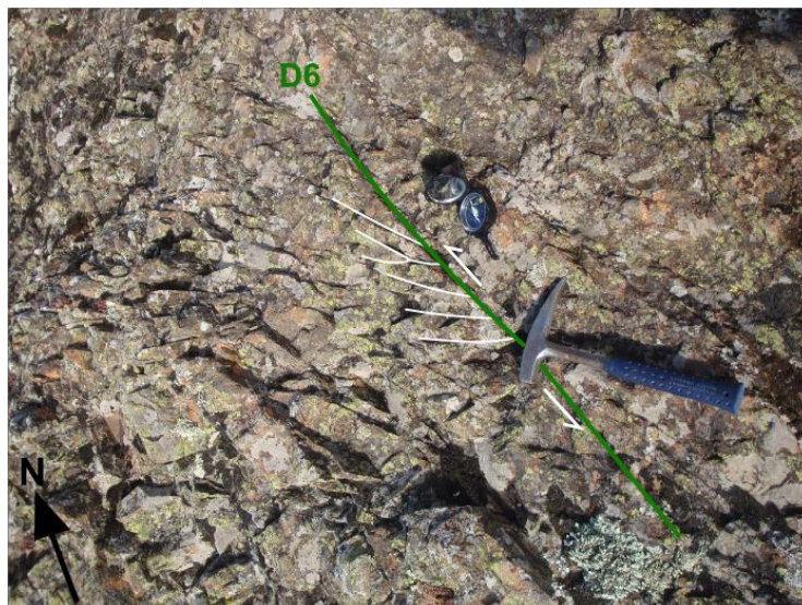
Figura 17. Estructura en “cola de caballo” en la Estación 2. Obsérvese el conjunto de fracturas secundarias en relación a la terminación de una diaclasa de la familia de orientación 065, 90 (D6), desplazada con un movimiento sinistral
