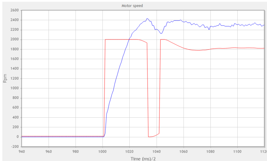
Figura C.1 Respuesta del sistema con control lineal-no lineal.
