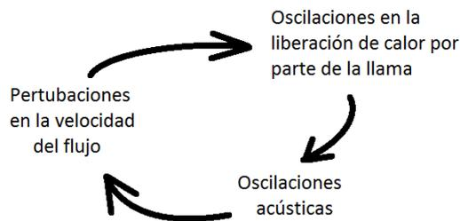
**Figura 3:** Esquema de la realimentación feedback.
