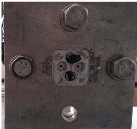
**Figura 43:** Chapa con los orificios para la colocación de los TP.
