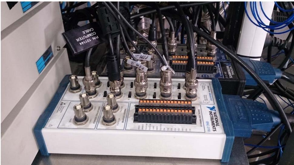
**Figura 36:** Tarjeta de adquisición de datos.
