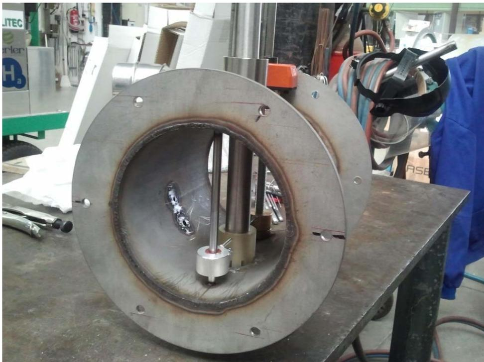
**Figura 28:** Plenum desmontado con el perno de restricción montado
