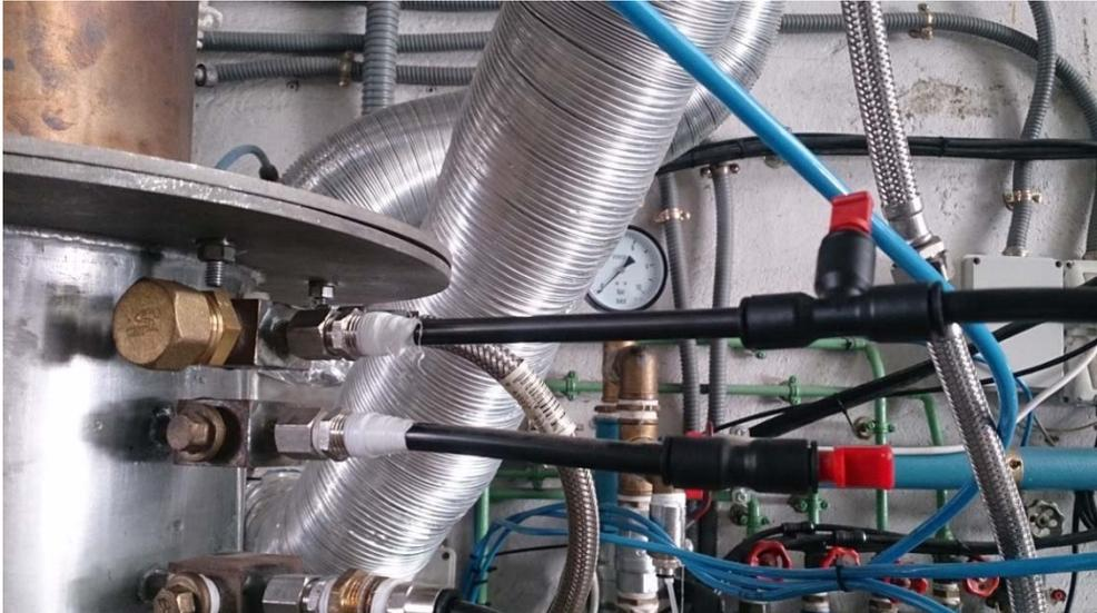
**Figura 32:** Guía semi-infinita de un TP en la cámara de combustión.
