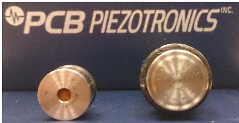
**Figura 34:** Transductores de presión (TP) con distintas superficies de medida. PCB Piezotronics 106B (derecha) y PCB Piezotronics 103B02 (izquierda).
