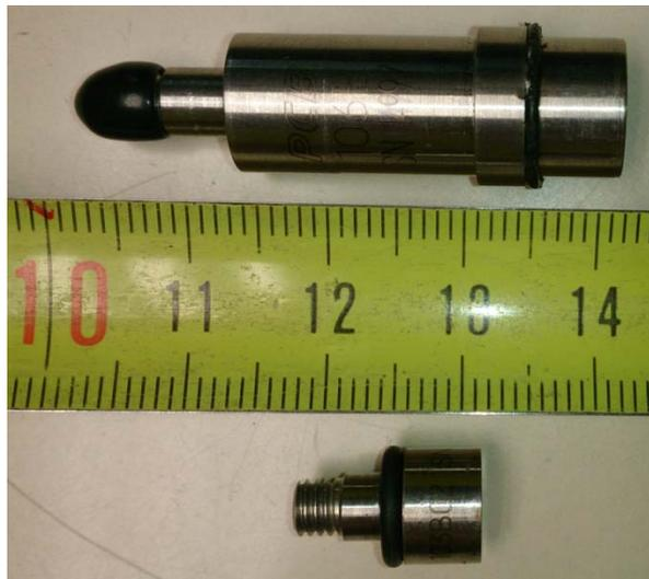
**Figura 33:** Transductores de presión (TP). PCB Piezotronics 106B (arriba) y PCB Piezotronics 103B02 (abajo).
