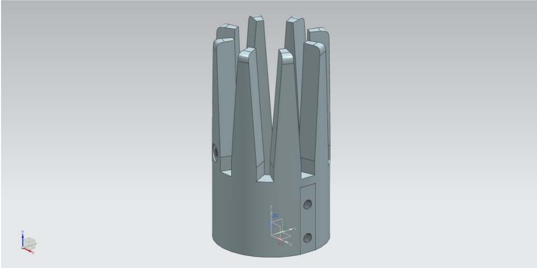
**Figura 29:** Modelo informático del perno de restricción.
