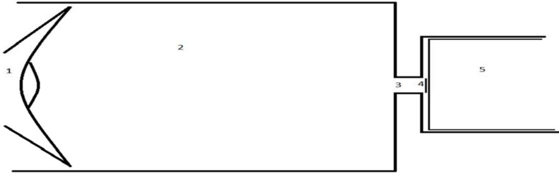
**Figura 45:** 1. Altavoz, 2. Tubo por el que se transmite el sonido, 3. Orificio, 4. Superficie sensible de medida, 5 TP modelo 103B02.
