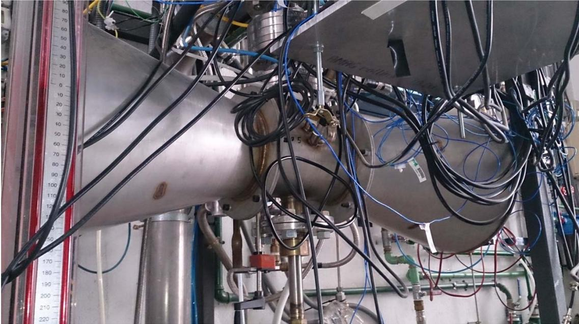
**Figura 27:** Plenum de entrada al conducto anular.
