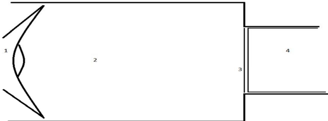
**Figura 44:** 1. Altavoz, 2. Tubo por el que se transmite el sonido, 3. Superficie sensible de medida, 4. TP modelo 106B.
