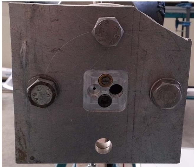
**Figura 40:** *Chapa con los orificios para la colocación de los TP.*
