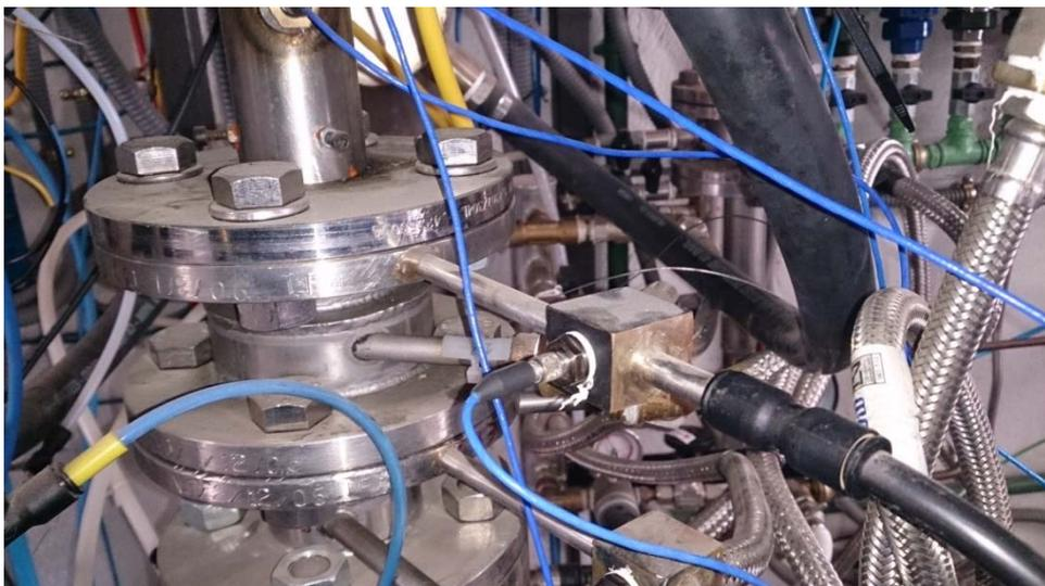
**Figura 31:** TP colocado en su posición (conducto anular) al final del tubo con la guía semi-infinita colocada a continuación de este.
