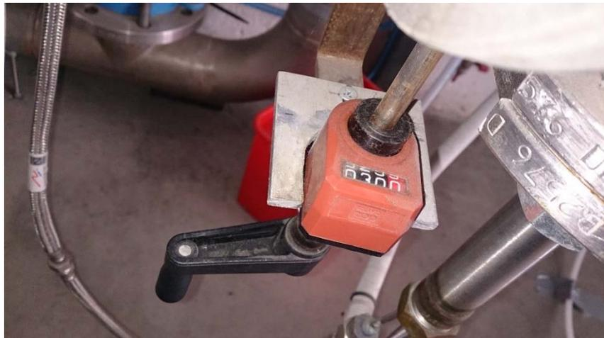
**Figura 30:** Cuentavueltas del perno de bloqueo. En la imagen en posición 30 vueltas.
