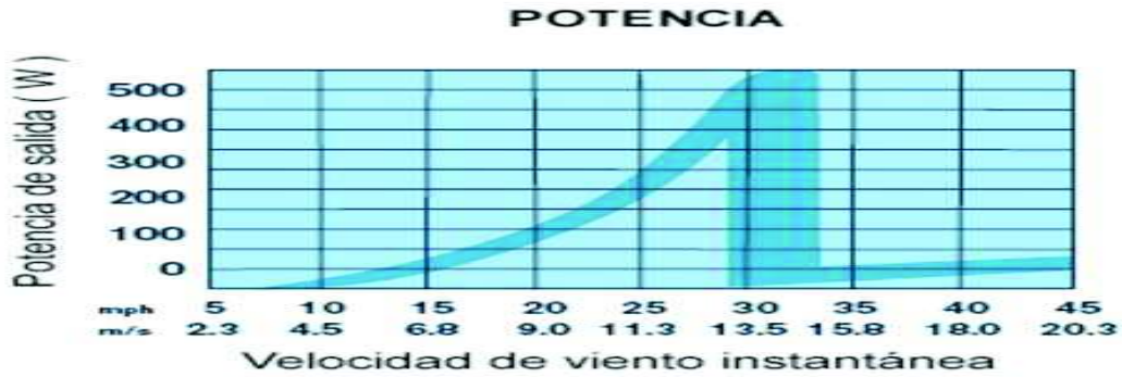
Figura 27. Curva de velocidad del viento - potencia (W) del aerogenerador AIR X ( http://www.aerogeneradores-air.com.ar/air-x.html )
