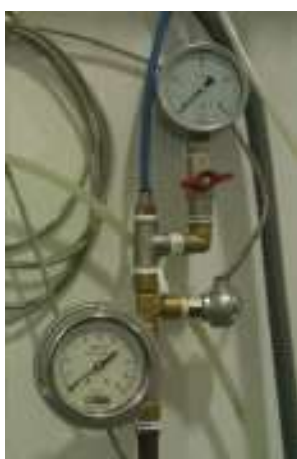
Imagen 3: Manómetro circuito agua y detalle de rotámetros utilizados en el circuito de agua.
