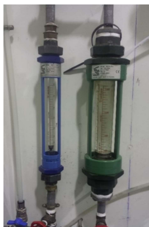
Imagen 3: Manómetro circuito agua y detalle de rotámetros utilizados en el circuito de agua.
