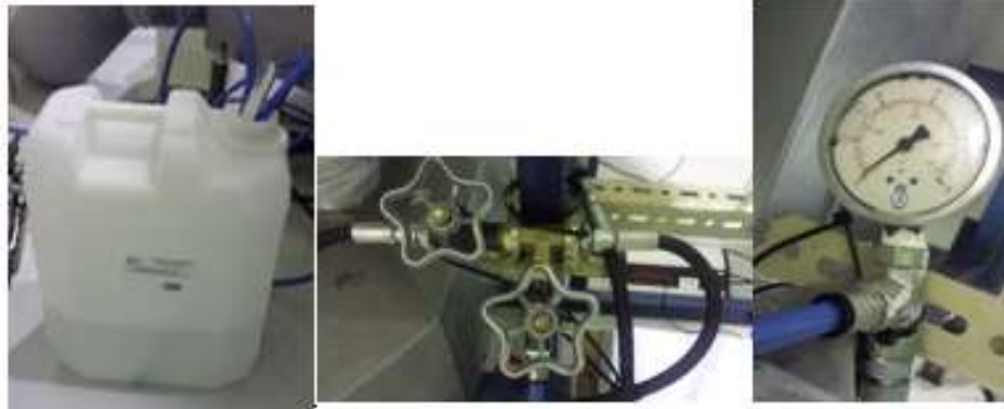
Imagen 5: Elementos constituyentes del circuito de glicerina. Garrafa de glicerina (izq.), regulador by-pass (centro), manómetro de hasta 25 bares (drcha.)
