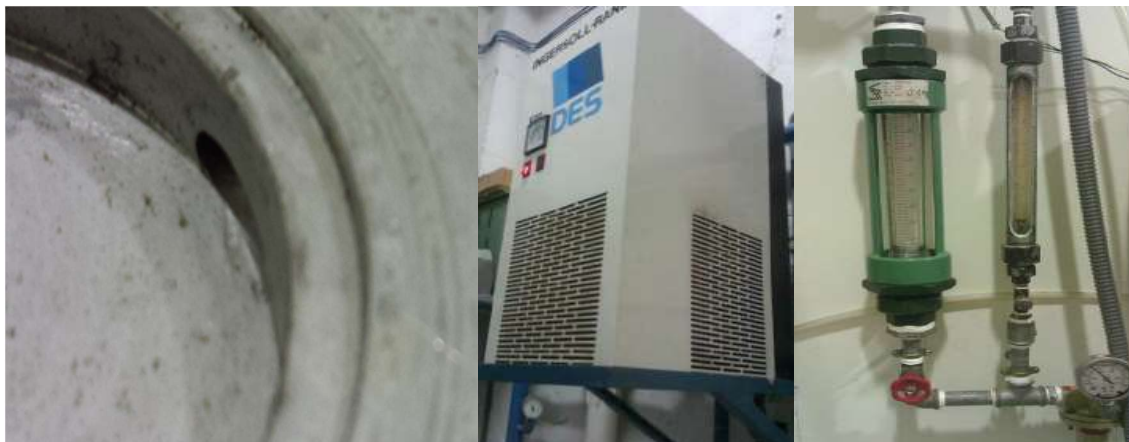
Imagen 7: Detalle entrada tangencial, compresor y rotámetro de aire utilizado por el sistema auxiliar de aire
