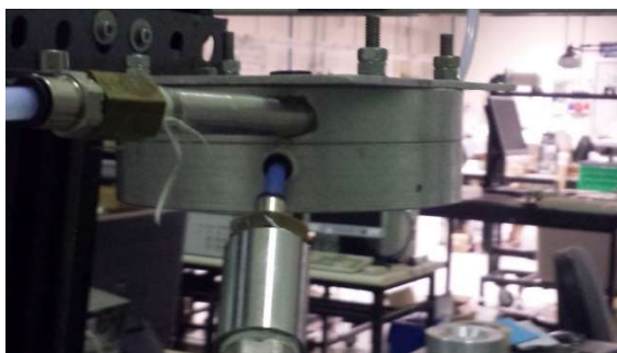
Imagen 11: Detalle entrada tangencial del aire y entrada líquido en el dispositivo atomizador.
