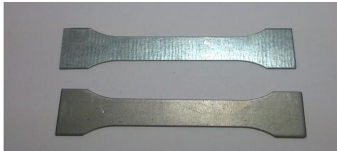
Imagen nº 11: Probetas de chapa de acero galvanizado (arriba) y de acero desnudo (abajo).
