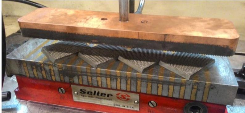
Imagen n° 22: Procedimiento de electroerosión en las mordazas.
