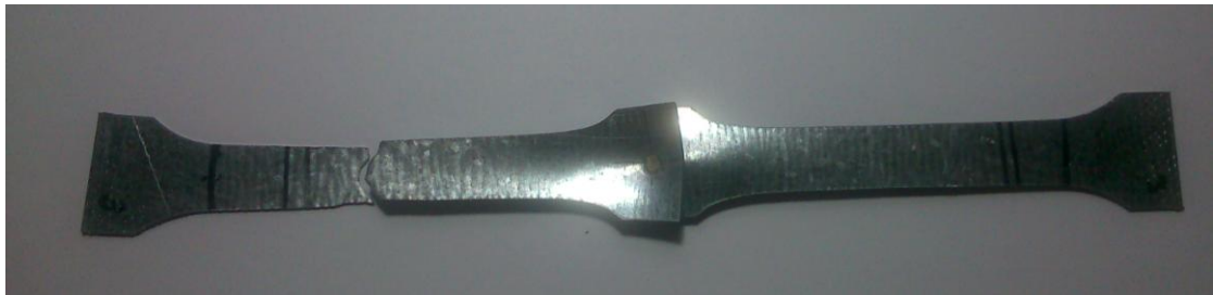
Imagen n° 65: Probeta n° 3 tras el ensayo.
