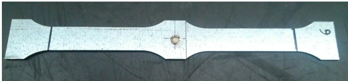
Imagen nº 49: Probetas unidas con la máquina de soldadura por resistencia.
