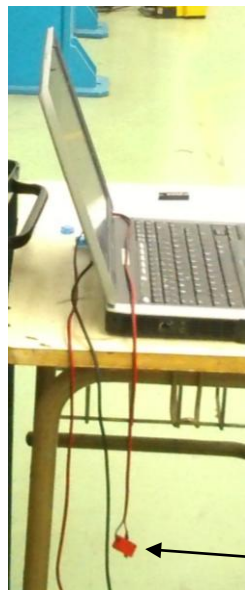
Imagen n° 58: Pulsador fin de carrera para desconectar el motor del grupo hidráulico.
