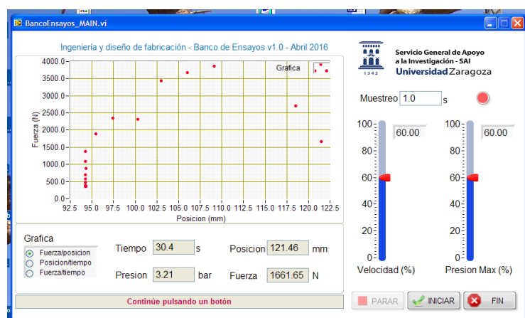
Imagen nº 56: Gráfica con los puntos que recibe el programa de los datos de los sensores.
