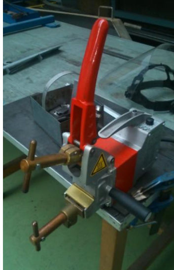
Imagen nº 30: Máquina de soldadura por resistencia.
