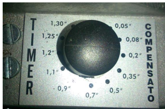
Imagen nº 33: Selector de tiempo de la máquina de soldadura.
