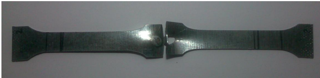
Imagen n° 64: Probeta n° 2 tras el ensayo.
