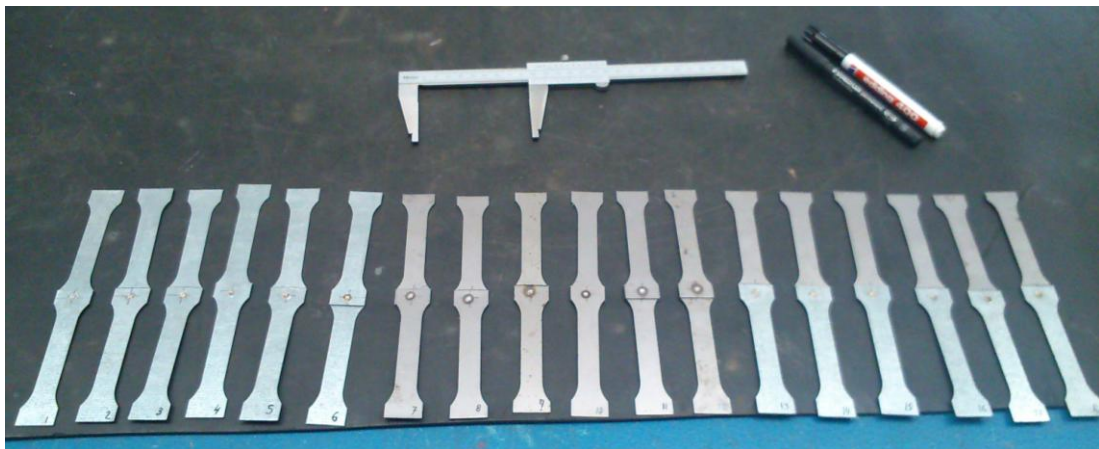
Imagen nº 50: Probetas unidas y numeradas antes de realizar los ensayos de tracción.
