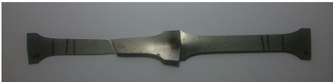
Imagen n° 71: Probeta n° 9 tras el ensayo.
