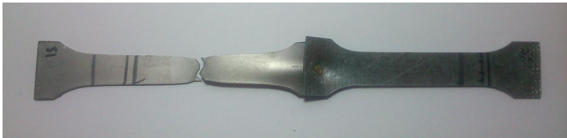
Imagen n° 77: Probeta n° 15 tras el ensayo.
