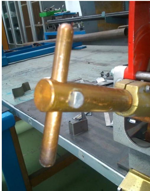
Imagen nº 34: Detalle del electrodo de la máquina de soldadura.
