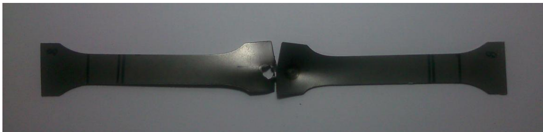
Imagen n° 70: Probeta n° 8 tras el ensayo.
