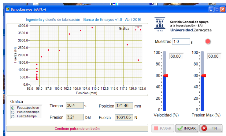
Imagen nº 54: Pantalla inicial donde se ponen los valores de velocidad y presión máxima.
