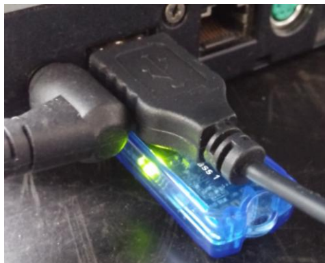
Imagen n° 45: Detalle de la conexión BLUETOOTH.
