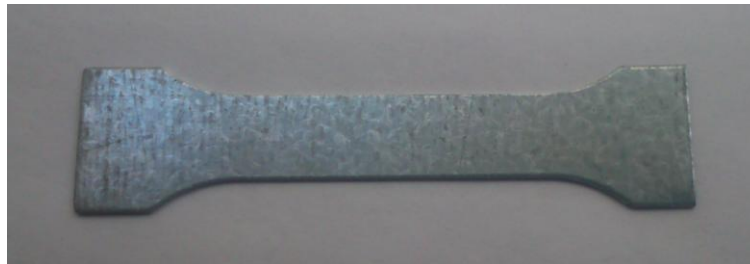
Imagen nº 28: Probeta individual de acero galvanizado.
