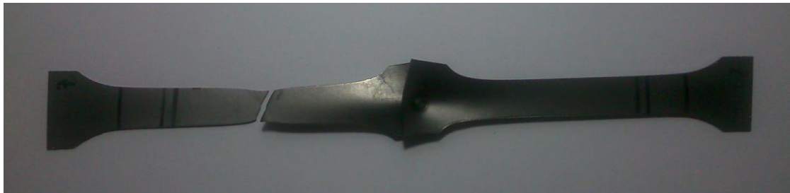
Imagen n° 69: Probeta n° 7 tras el ensayo.
