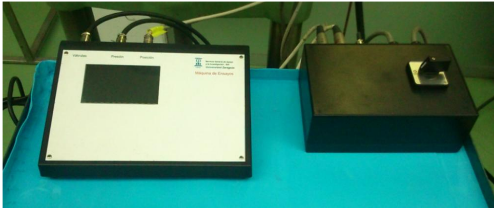
Imagen nº 51: Cajas de interconexión máquina-ordenador (izda.) y de encendido de motor (dcha.).
