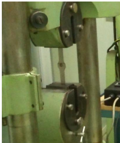
Imagen nº 53: Vista de la probeta en las mordazas.
