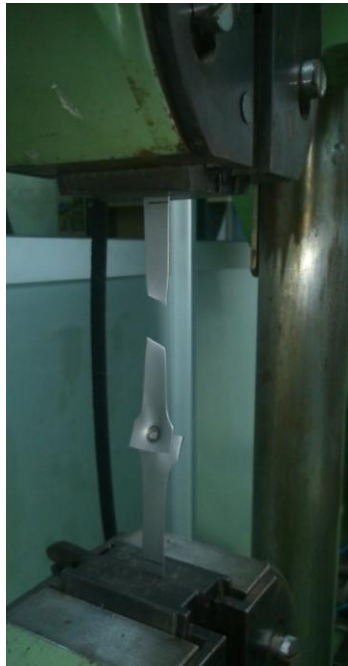
Imagen n° 57: Rotura de la probeta.
