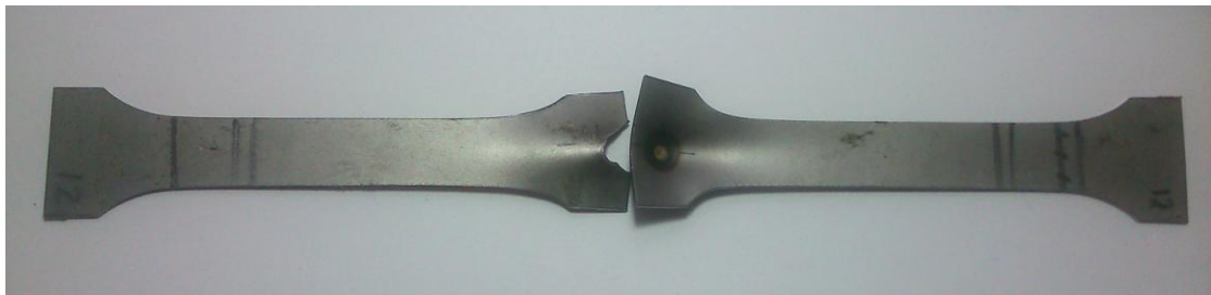
Imagen n° 74: Probeta n° 12 tras el ensayo.
