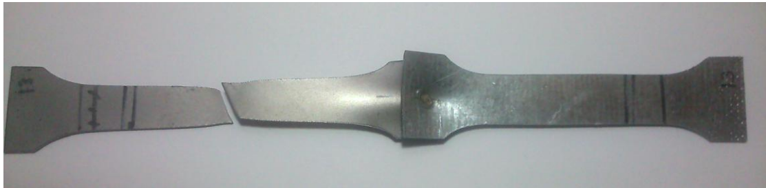
Imagen n° 75: Probeta n° 13 tras el ensayo.
