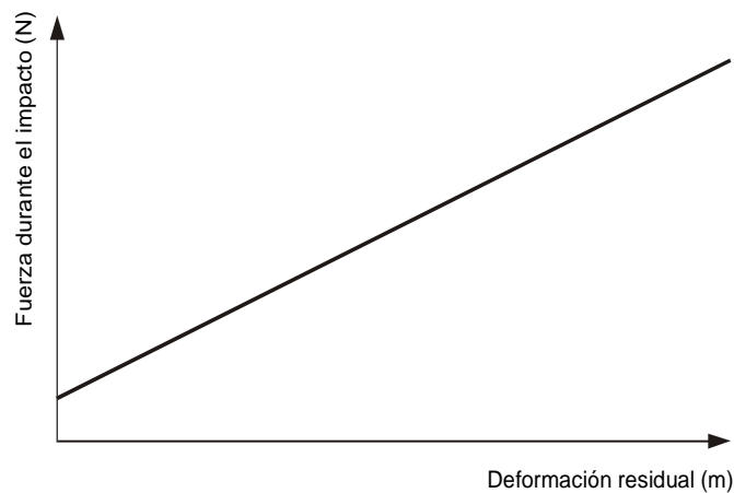
Figura 20. Deformación residual frente a fuerza durante el impacto
