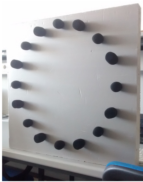
Figura 3.1: Agrupación de micrófonos utilizada para la implementación en tiempo real y para las grabaciones usadas para el estudio de los diversos algoritmos presentados en el capítulo 2.
