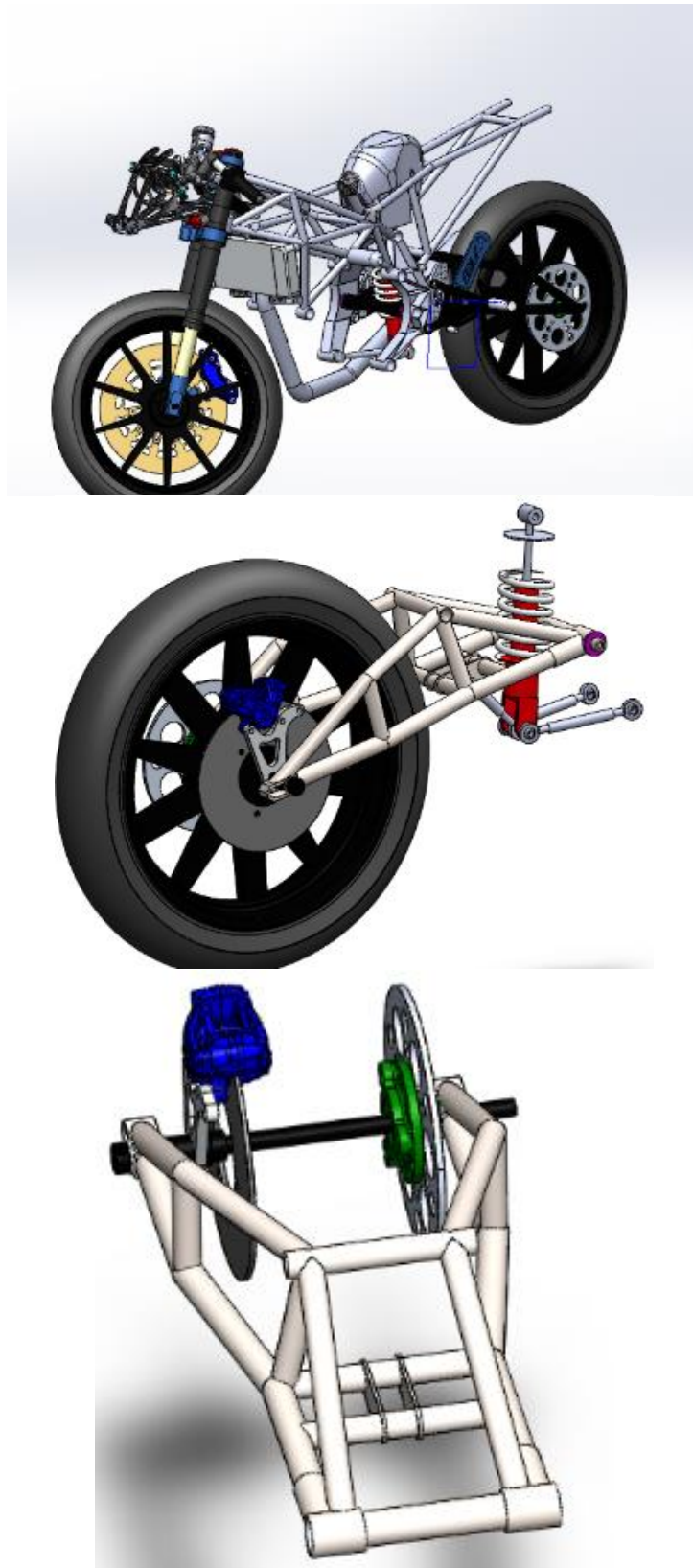
Figura 32, 33 y 34: ensamblaje global de la moto, ensamblaje tren trasero y ensamblaje basculante con elementos de la rueda trasera
