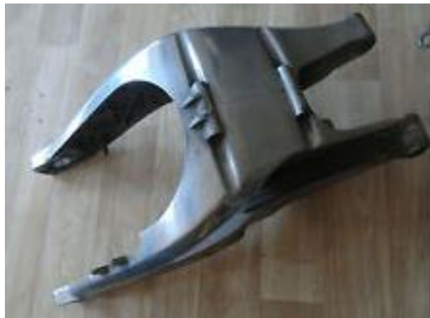
Figura 5: basculante Aprilia RS 125
