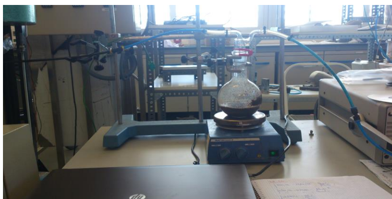
Figura II-4. Experimento de lodo tratado con ácido en el que los gases generados durante la impregnación son recogidos y analizados para la contabilización de C en forma de \text{CO}_2
