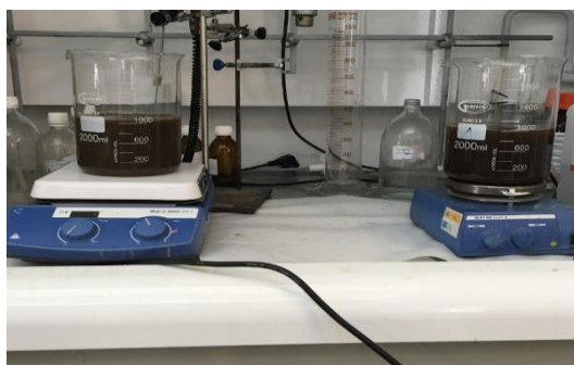
Figura 2. Sistema experimental de extracción de fósforo y activación química del lodo
