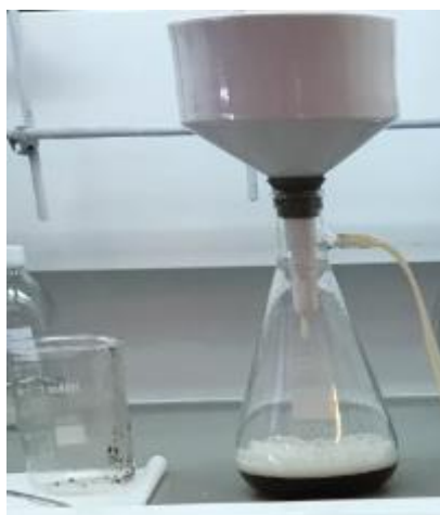
Figura 3. Sistema experimental de filtrado y lavado del lodo
