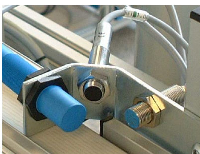
Figura A.4: sensores capacitivo, óptico e inductivo, por orden, a la entrada de la estación.
