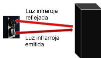
Figura 2.10: Representación del funcionamiento del sensor óptico.
