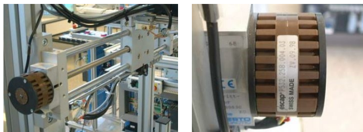
(a) Ubicación Stepper en el eje X o Vía 0 (b) Primer plano Stepper. Vista lateral.
