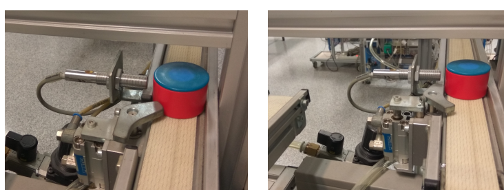
(a) Tope cerrado. Bloquea el paso de piezas. (b) Tope abierto. Permite el paso de piezas.
