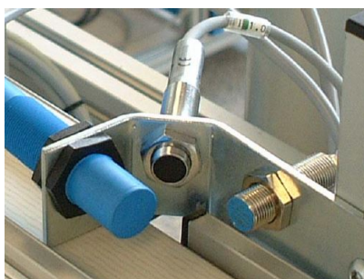
Figura 2.8: sensores capacitivo, óptico e inductivo, por orden, a la entrada de la estación.
