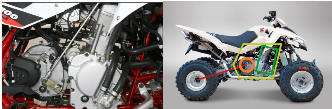
Imagen 6. Motor original y esquema de ubicación de los nuevos componentes eléctricos
