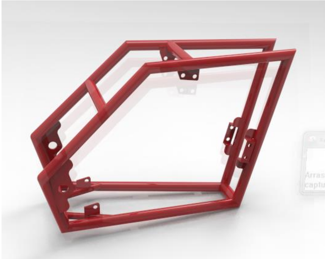
Imagen 7. Modelado del chasis del vehículo y ubicación precisa de los anclajes originales
