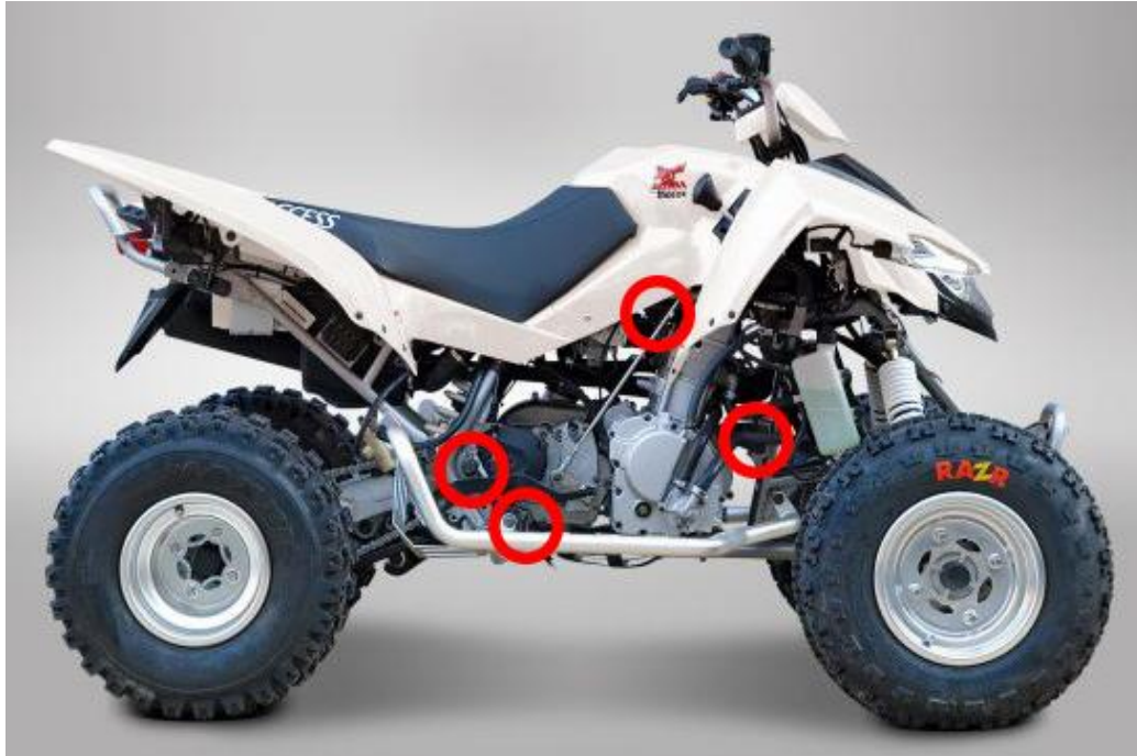
Imagen 5. Ubicación de los anclajes del motor en el chasis del vehículo
