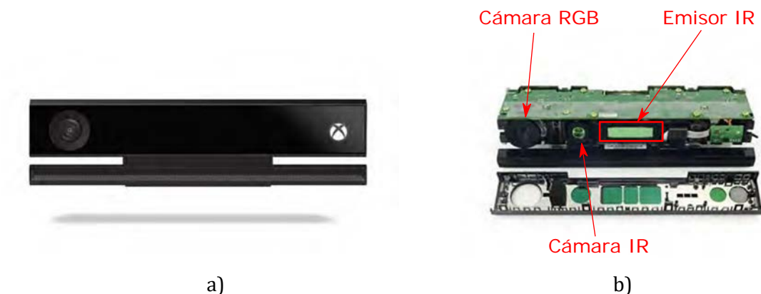
Figura 2.1. Kinect v2. a) Dispositivo tal y como se suministra. b) Dispositivo desensamblado para observar su interior
