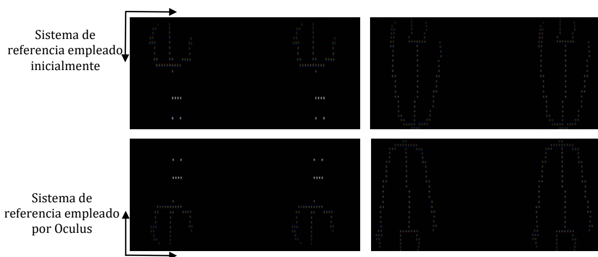
Figura 4.8. Ejemplos de representación en Oculus antes (arriba) y después (abajo) de cambiar el sistema de referencia de la imagen
