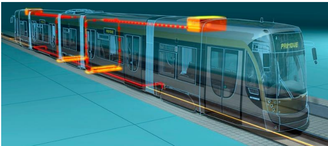
Imagen 4 y 5. Ejemplos de carga inductiva en tranvías[7]
