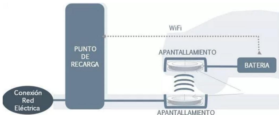
Imagen 1 : Carga inductiva en vehículo eléctrico[10]
