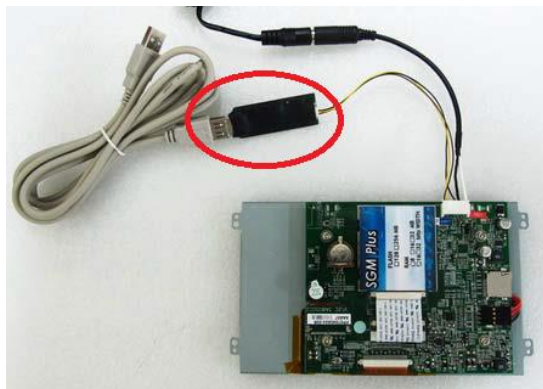
Figura 28. Parte trasera de la pantalla TFT táctil de donde sale el cable RS-232 junto con el adaptador usado para su conexión al puerto serie del ordenador
