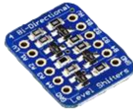
Figura 34. Adaptador bidireccional de tensión para la conexión entre la pantalla TFT táctil y el microcontrolador de la consola de Mondo
