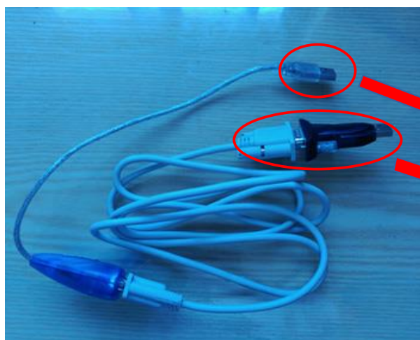
Figura 29. Cable RS-232 con dos adaptadores RS-232 a USB para der conectado al ordenador
