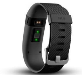
Figura 25: Sensor de pulso óptico flanqueado por dos LED
