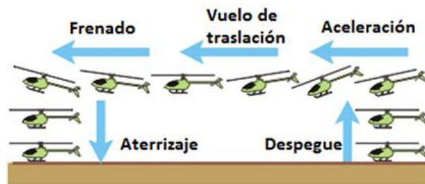
Figura 2.4.3: Vuelo de traslación y frenado de un helicóptero.
