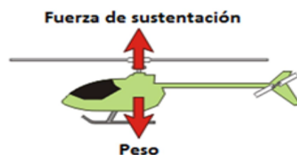
Figura 2.4.1: Diagrama de fuerzas básico de un helicóptero.
