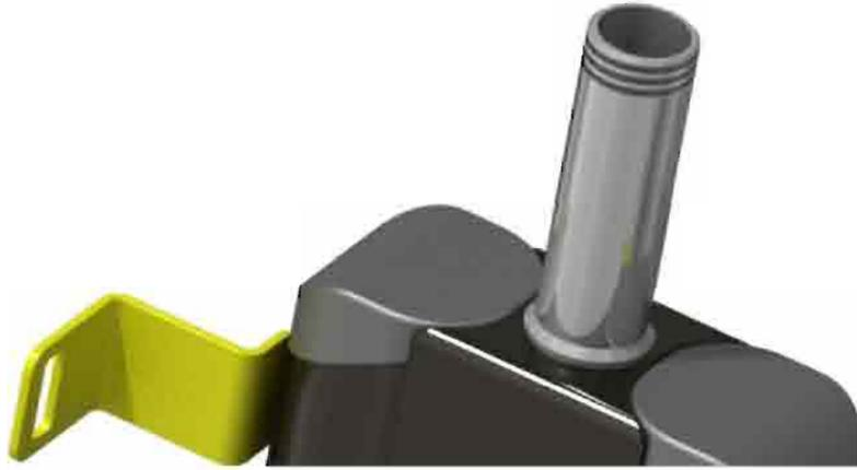
La plataforma de carga se anclará en tres puntos y tendrá dos apoyos auxiliares. El apoyo trasero tiene un anclaje con tope, que evita el desplazamiento de la plataforma de carga. El otro tope delantero evita que la plataforma varíe en altura. Lleva unos muelles para que la carga no se desestabilice si topa con un bache.
